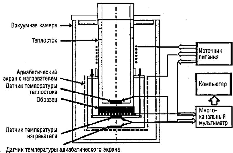
датчиков температуры измеряли многоканальным мультиметром на базе ЛЦП AD7794. Весь процесс измерений регистрировали при помощи персонального компьютера.
