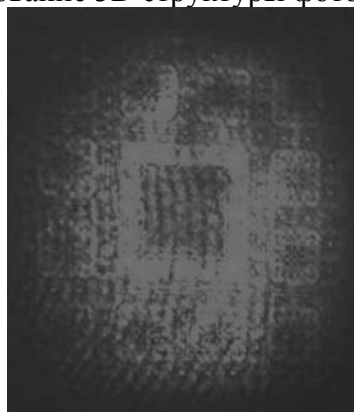
Рис.1 Дифрактал ковра Серпинского с шагом решетки в длину Талбота
