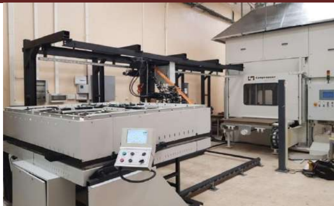
Рис. 1. Опытная автоматизированная линия термоштамповки ТКМ
