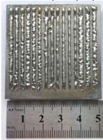
Рис. 1. Фотография образца с единичными треками при разных режимах наплавки
