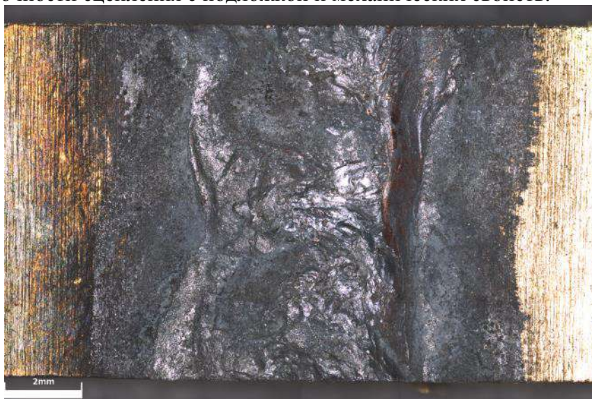
Рисунок 1. Область отрыва покрытия от подложки
