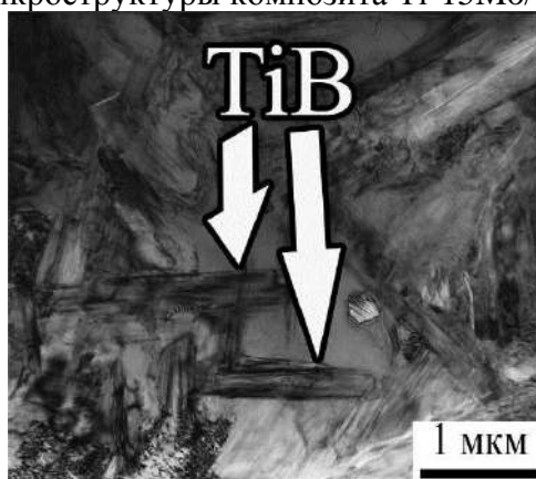
Рис. 2. ПЭМ изображение микроструктуры композита Ti-15Mo/TiB
