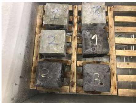
Рисунок 3 – Испытание образцов на морозостойкость
