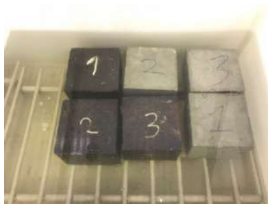
Рисунок 2 – Испытание образцов на водопоглощение
