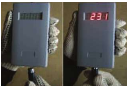
Рисунок 1 – Процесс коммутации датчика к электронному преобразователю
