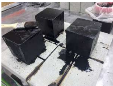
Рисунок 1 – Образцы, обработанные пропиткой ПС-1
