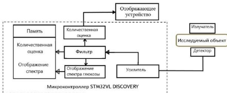
Рисунок 3 – Блок – схема концептуального глюкометра
