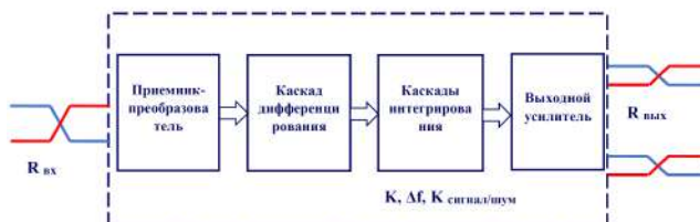
Рисунок 2 –Блок-схема формирующего усилителя
