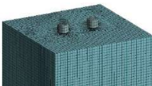
Рисунок 4 – Построение расчётной сетки в Ansysworkbench
