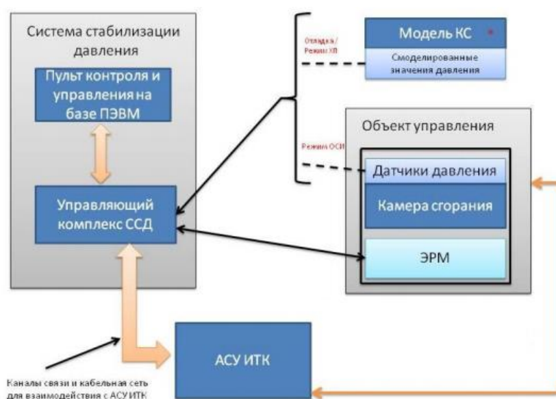
Рисунок 1 – Схема стендовой системы стабилизации давления
