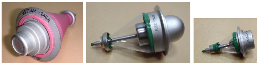
Рисунок 3 – Рентгеновские трубки, применяемые в аппарате ПИР-200М
