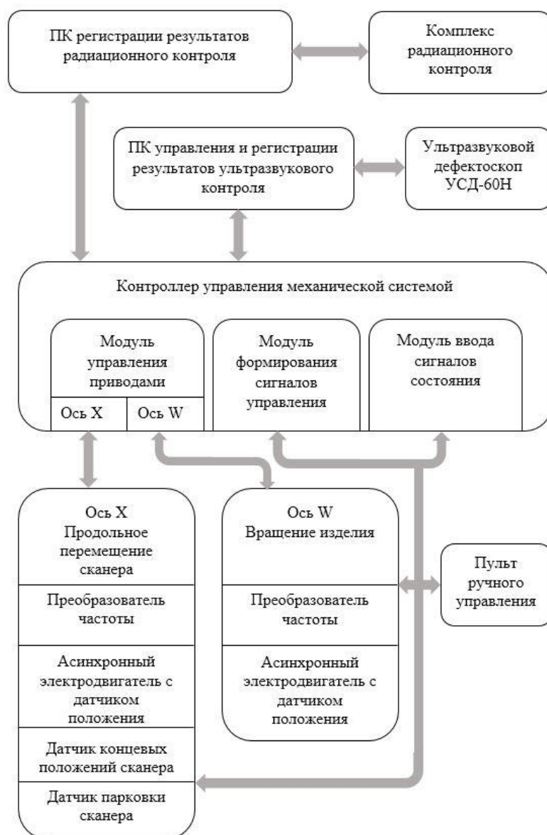
Блок-схема автоматизации комплекса дефектоскопии сложнопрофильных изделий из ВКМ
