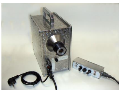
Рисунок 5 – Портативный ИРА с напряжением 150 кВ с регулированием частоты от одиночных вспышек по команде до 400 Гц
