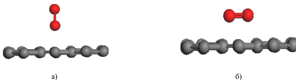
а) ось молекулы O_2 перпендикулярна плоскости графена; б) ось молекулы O_2 параллельна плоскости графена.
