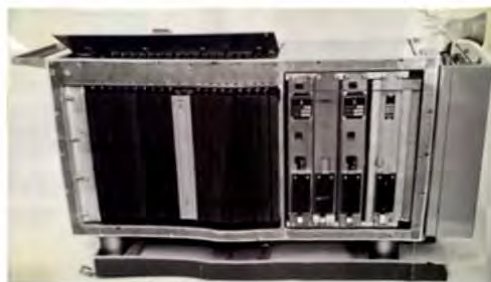
Рис. 2.3 «Гном – А» с открытой передней крышкой и пультиком УУР Устройство управления резервом .
