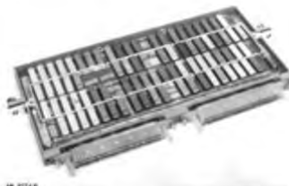
Рис. 5.2 Конструкция МГ «Гном1-66» со стороны модулей «Квант».
