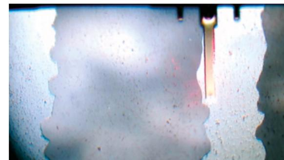
Рис. 2. Планарные микроструктуры, сформированные с помощью фотолитографии.
