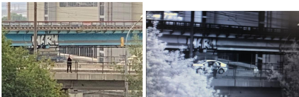
Рисунок 4 – Фрагменты изображения, полученные в видимом диапазоне посредством цветной телевизионной камеры и в SWIR диапазоне посредством экспериментального образца
