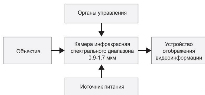
Рисунок 3 – Структурная схема прибора и его внешний вид
