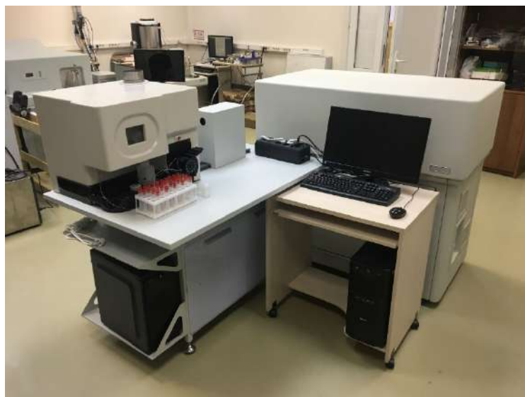
Рис. 1. Внешний вид спектрометра «Гранд-СВЧ» в исполнении с разделенным спектрометром и источником возбуждения спектров
