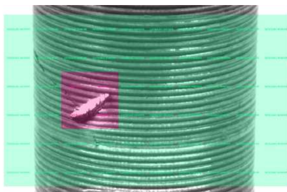
Рис. 4. Обнаружение царапины на нижней заглушке
