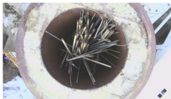
Рис. 3. а – размещение роботов на стапеле при обследовании контейнеров на ПВХТРО; б – содержимое бетонного контейнера БЕТ-2 – фрагменты термодпар и стержней СУЗ
