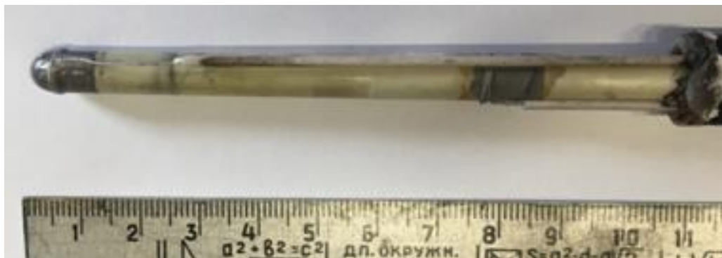
Рис. 6. Внешний вид сенсора после длительных измерений в расплаве \text{LiCl-Li}_2\text{O}
