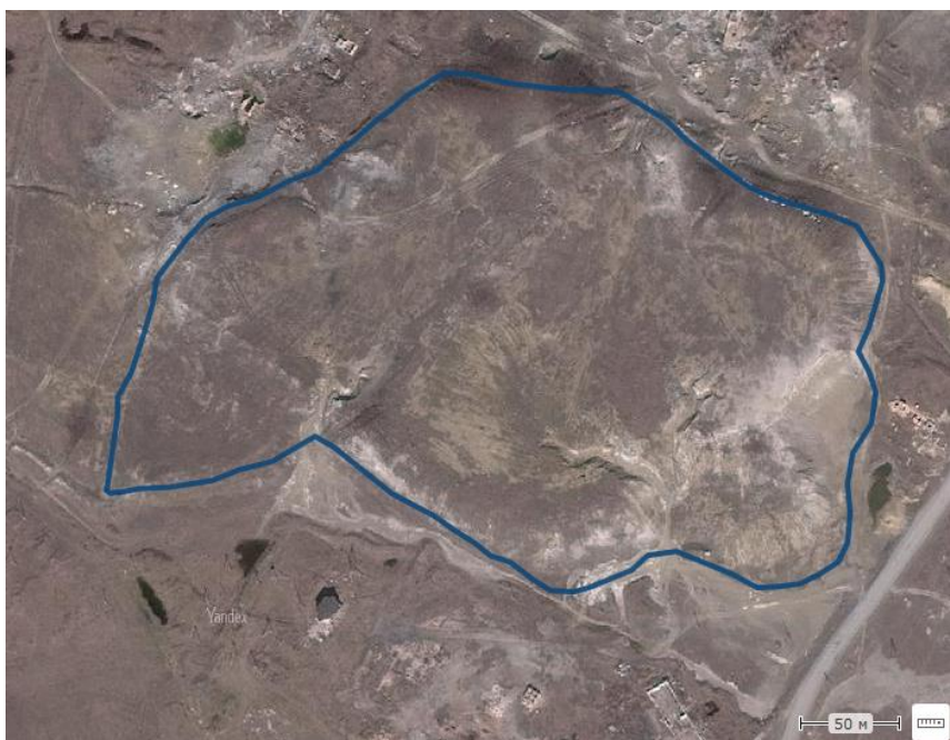
Рис.2. Оконтурированная площадь Новотроицкого хвостохранилища на космоснимке с развитой по его склонам эрозионной формой рельефа.
