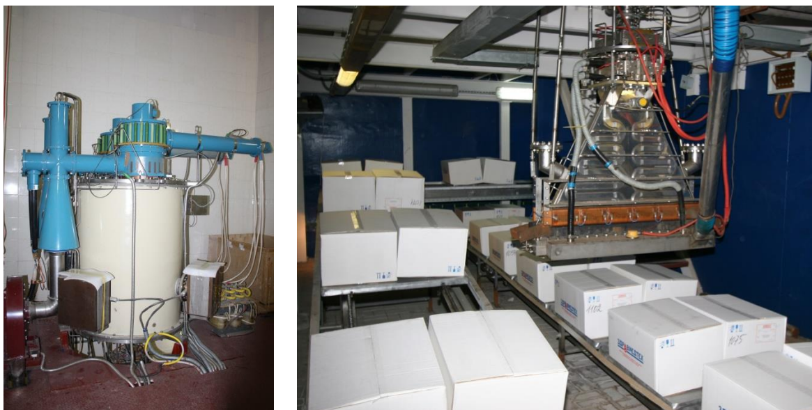
Рис. 2. Ускоритель ИЛУ-10 и коробки с одноразовым медицинским бельём на конвейере под его выпускным устройством
