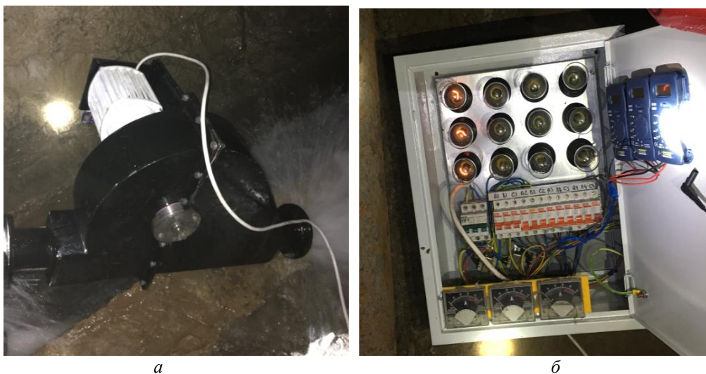
Рис. 1. Внешний вид испытуемой установки: а – смонтированная на трубопровод скважины гидротурбина, б – нагрузочно-измерительный стенд
