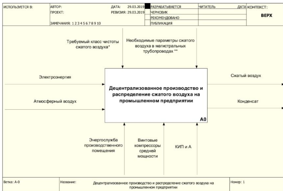
Рис. 8. Контекстная диаграмма процесса децентрализованного производства и распределения сжатого воздуха на промышленном предприятии: *Требуемый класс чистоты сжатого воздуха, соответствующий нормативным показателям стандарта ГОСТ Р ИСО 8573-1-2016; **Необходимые параметры сжатого воздуха (давление, расход) в магистральных трубопроводах системы воздухообеспечения, согласно требованиям заводского регламента
