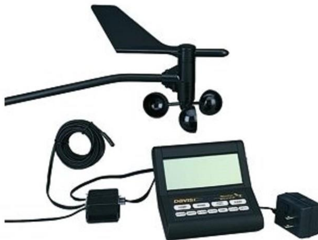
Рис. 2. Мобильная метеостанция Davis 7425EU с блоком датчиков
