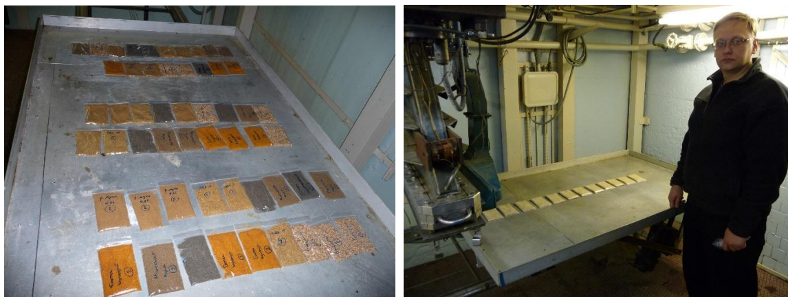
Рис. 1. Образцы комбикормов и их ингредиентов под выпускным окном ускорителя ИЛУ-6
