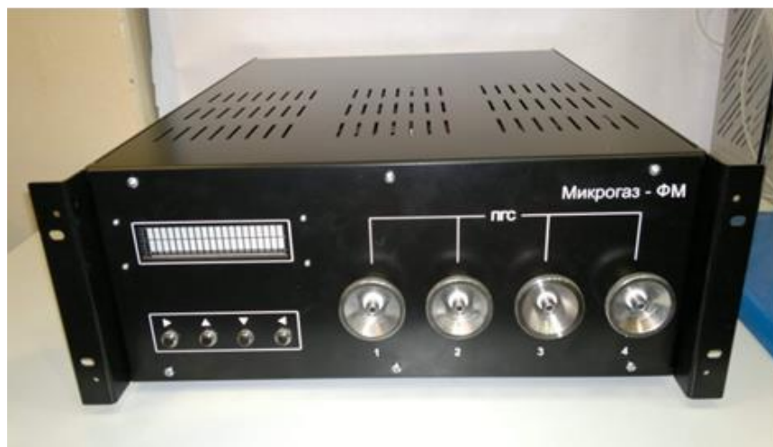
Рис. 1. Внешний вид лабораторной модификации «Микрогаз-ФМ»
