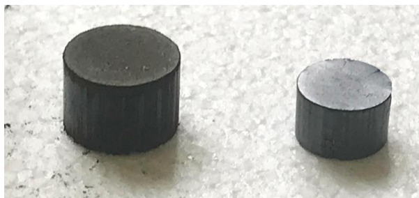
Рис. 1. Фотографии таблеток диоксида урана: (слева) прессованной и (справа) спеченной при воздействии СВЧ излучения
