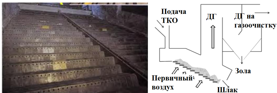
Рис. 2. Внешний вид (слева), схема работы наклонно-переталкивающей колосниковой решетки.
