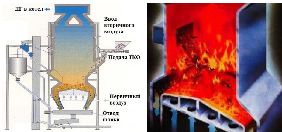
Рис.3. Внешний вид топочного устройства с вихревым кипящим слоем.
