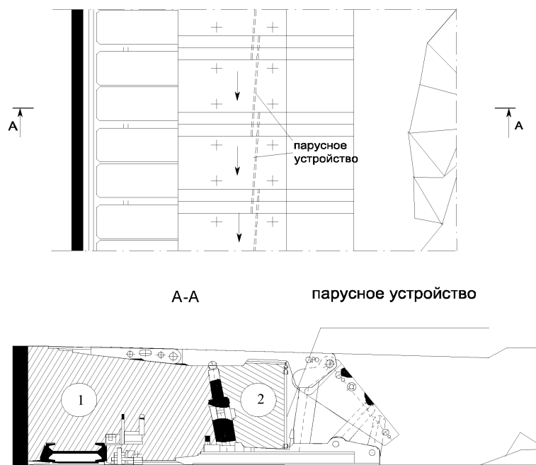
Рис. 1. Схема навески парусного устройства в лаве и положения измерительных станций 1 и 2 при поперечных съемках метановоздушных потоков
