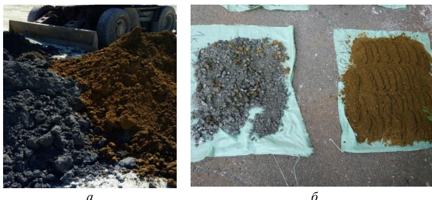
Рис. 2. Результаты пилотной селективной разработки хвостохранилища с применением колесного погрузчика (а) и выделенные две отдельные фракции с повышенным содержанием цветных и благородных металлов (б)
