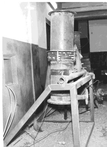
Рис. 2. Установка для обмолота початков кукурузы, труба диаметром 300 мм.
