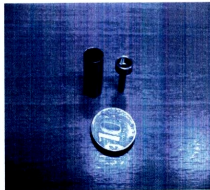
Рис. 2. Миниатюрная ампула реперной точки натрия
