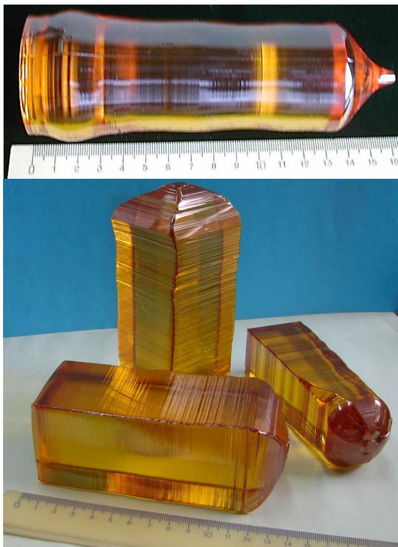
Рис. 6. Кристаллы молибдата натрия висмута NaBi(MoO_4)_2 , выращенные по методу Чохральского [7, 8]
