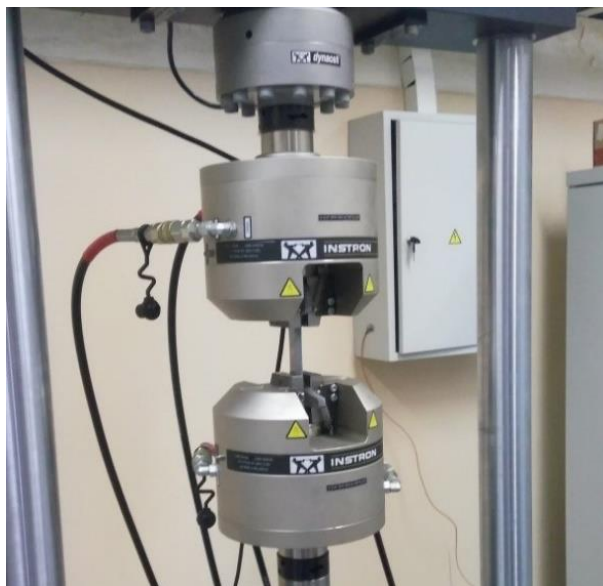
Рис. 2. Экспериментальная установка для выращивания трещины в шейке рельса.
