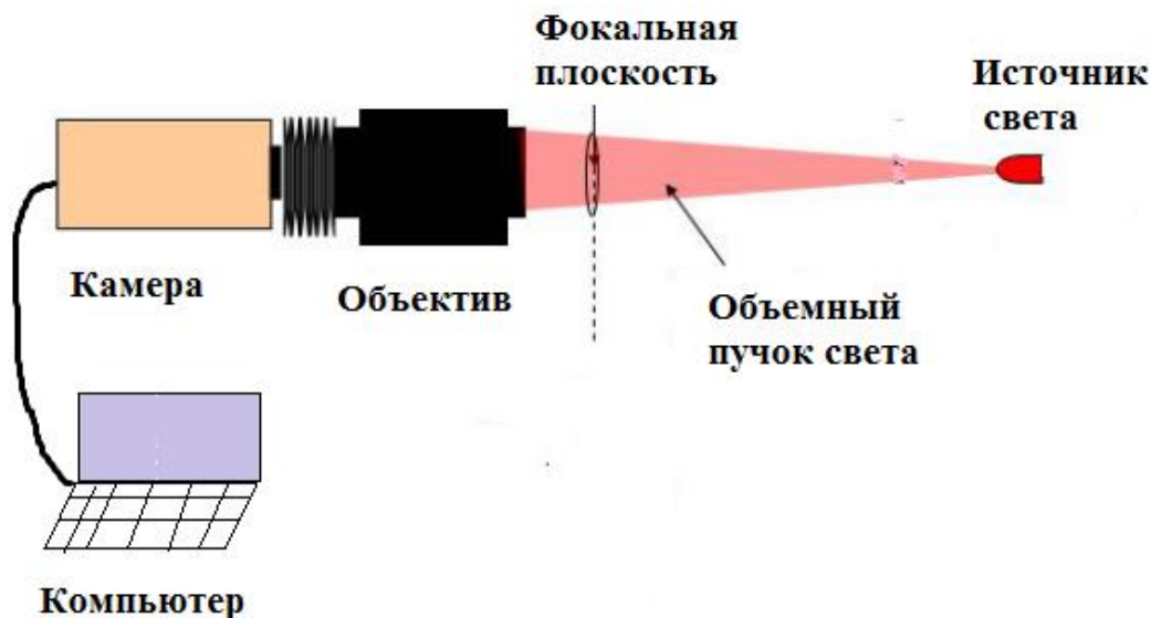
Рис. 1. Схема экспериментальной установки теневого метода
