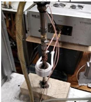
*Рисунок 2 – Макет вольфрамового модуля теплозащитной облицовки дивертора, установленный в контур системы охлаждения, с индукционным нагревателем*
