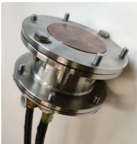
Рисунок 2 – Общий вид макета литиевого дивертора на основе КПС токамака КТМ
