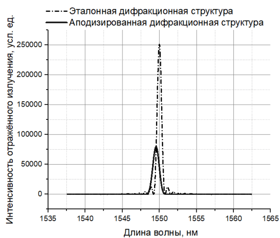
рис 3. Зависимость интенсивности излучения, отражённого от рассматриваемой структуры, от длины волны
