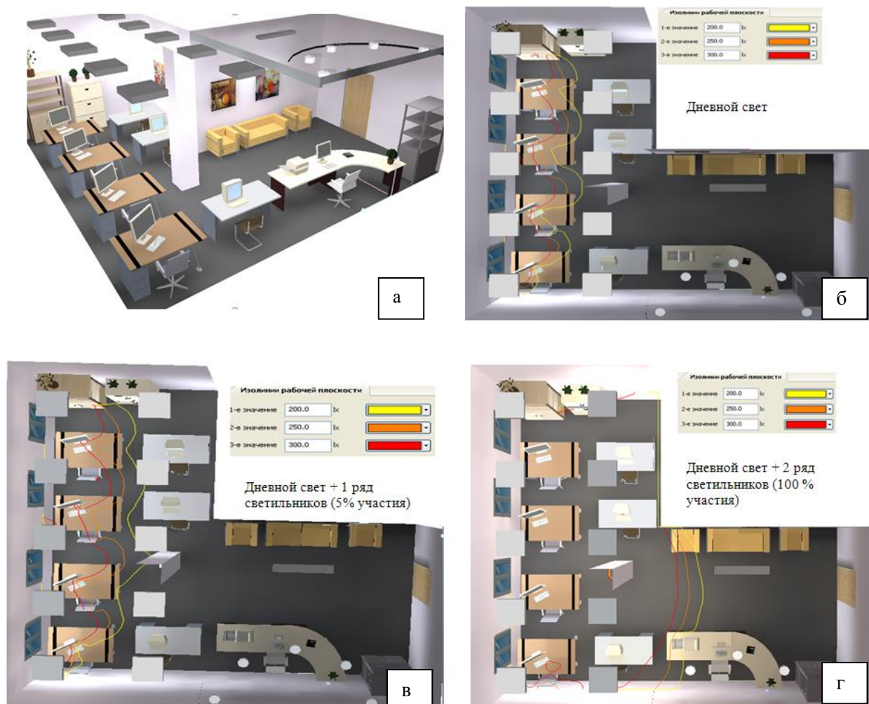
рис. 1 Демонстрация сцен освещения с элементами управления в режиме контроля естественного и искусственного света в программном комплексе DIALux
