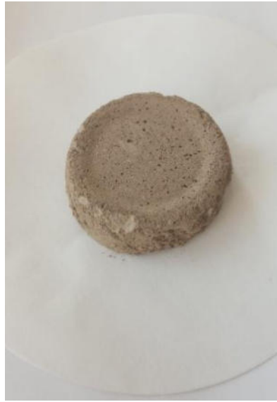
Рис. 1. Вид материала на основе гипсового связующего, полученного при утилизации отходов нанесения цинковых покрытий
