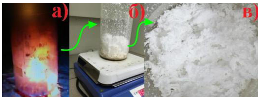
Рис. 1. Процесс синтеза нанопорошка BaZrO_3 (а и б) и его морфология (в) при небольшом увеличении
