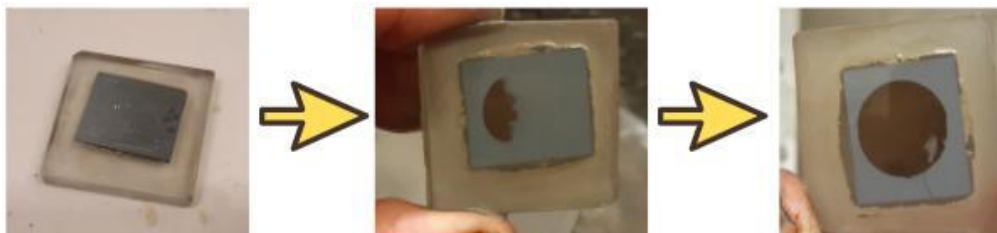
Рис. 2. Процесс проявления пористого слоя
