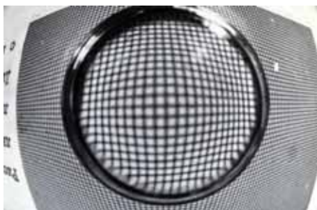
Рис. 2. Фотография миниатюрной линзы из кристаллического MgF_2 на опорной сетке с периодом 100 мкм, радиус кривизны линзы 2.0 мм.
