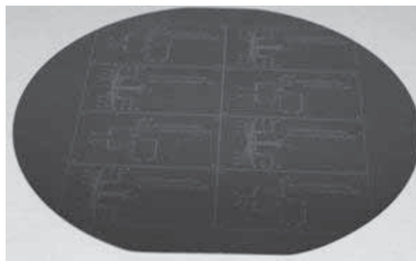
Рис. 2. Полупроводниковая пластина с «полуфабрикатом» чипов, совместимых с ESEM и ASEM.
