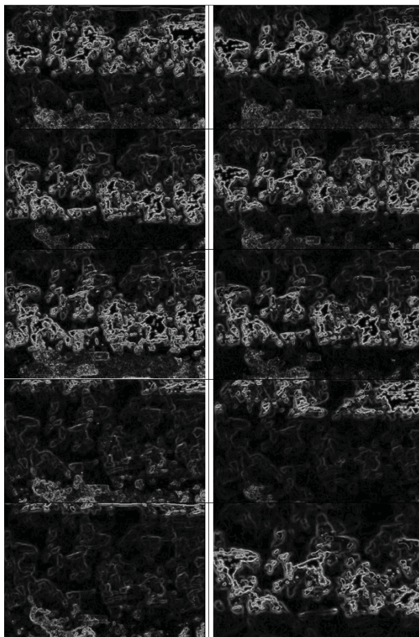
Рис. 3. Последовательность сканирования ВТСП с затуханием, выявляющие гранулярную структуру материала.
