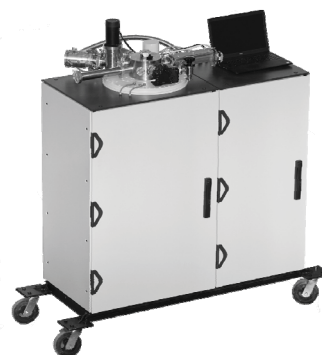
Рис. 1. Рентгеновский аппарат на основе X-пинча для исследований в области медицины и биологии.
