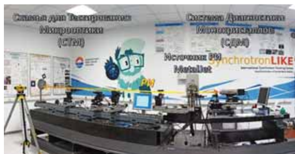
Рис.1. Фотография комплекса «SynchrotronLike». С левой стороны от рентгеновского источника MetalJet находится испытательный стенд для тестирования микрооптики, а с правой система диагностики монокристаллов.
