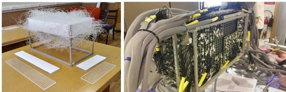
Рис. 2. Слева: прототип SuperFGD, собранный на лесках, перед заменой их на спектросмещающие волокна. Справа: частично собранный SuperFGD- прототип, повернутый на 90 градусов вокруг z-оси
