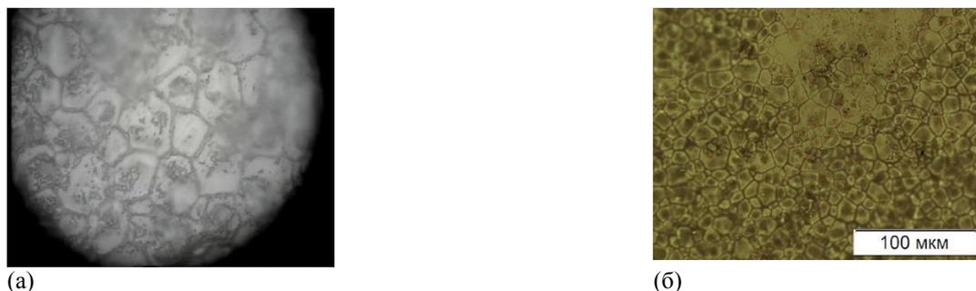
Рис. 4. Изображения поверхности керамики 0,5Pr:LuAG: (а) при увеличении в 300 раз, (б) при увеличении в 100 раз
