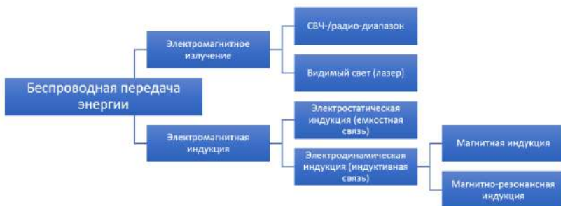
Рис.1 – методы передачи электрической энергии без использования проводов
