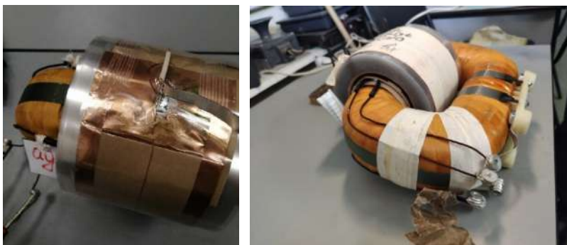
Рис. 1 – Фотоотчет экспериментов с трансформатором без литой изоляции ЗНОЛ.06 10 кВ
