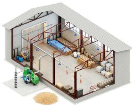
Рис.1 – воздушная система отопления
