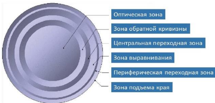
Рисунок 2 – Геометрия 6-ти зонной ОК-линзы
