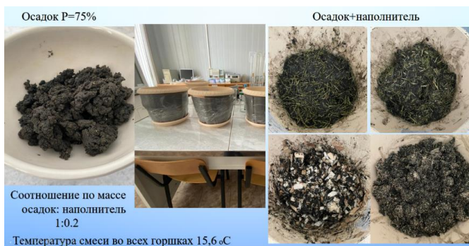
Рисунок 2 - Этапы подготовки осадка к компостированию
