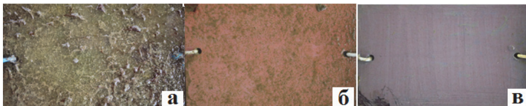
Рис. 3. Противообрастающая активность нанокompозитов ПММА@CuFe 2 O 4 -CuO в отношении морских гидробионтов: (а) - пластина без противообрастающего покрытия; (б) - контроль, стандартное покрытие, модифицированное Cu 2 O (5 % масс.); (в) - стандартное покрытие, модифицированное наночастицами CuFe 2 O 4 -CuO (5 % масс.)
