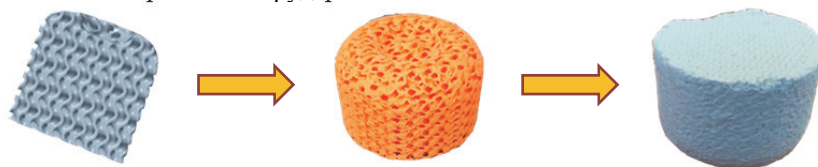
Рис. 2. Принципиальные ступени создания спроектированного катализатора с развитой геометрией
