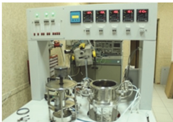
Фотография МОСVD установки
