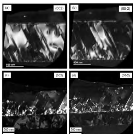
Рис. 1. Темнопольные ПЭМ изображения GaP/Si гетероструктуры, полученные в дифракционных рефлексах (002) и (00-2) (рис. (а) и (b), соответственно)
