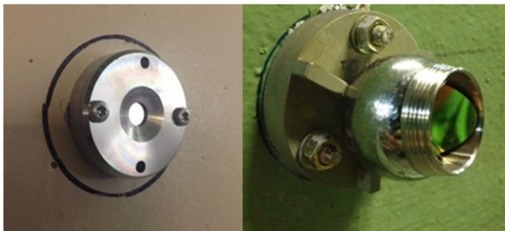
Рис. 4. Геодезические знаки с магнитным держателем отражателя
