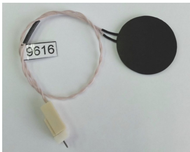
Рис. 2. Термопарный датчик теплового потока d = 27 мм.
