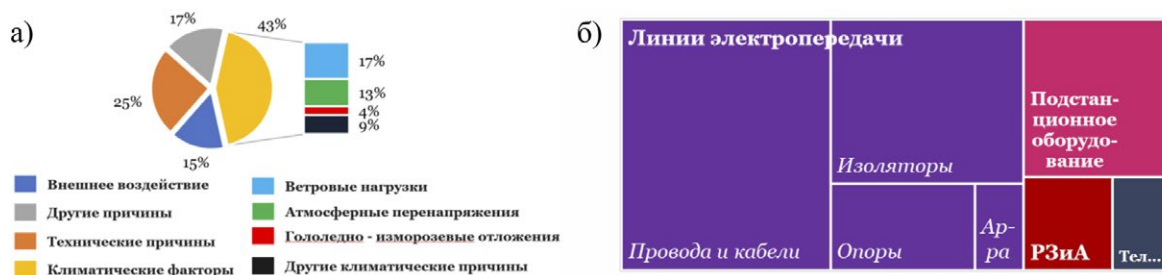
Рис. 1. Распределение долей технологических нарушений: а) по причинам (данные ПАО «Россети»); б) по объектам/элементам (по данным АО «СО ЕЭС»).
