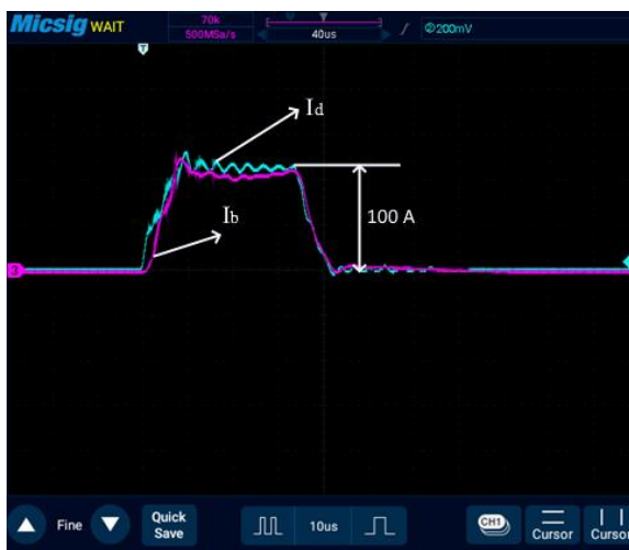
Рис. 4. – Осциллограммы тока разряда (CH2) и тока пучка (CH3) при различных давлениях
