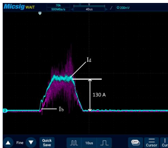
Рис. 4. – Осциллограммы тока разряда (CH2) и тока пучка (CH3) при различных давлениях
