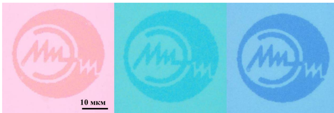
Рис. 3. Протяженные оптически контрастные RGB-изображения на поверхности структуры GIA`
