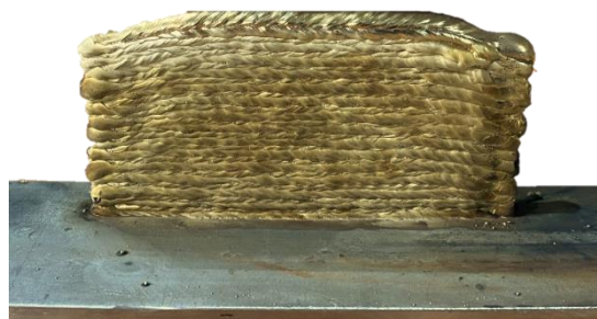
Рис. 2. 3D-печать стенки методом проволоочно-дуговой аддитивной технологии
