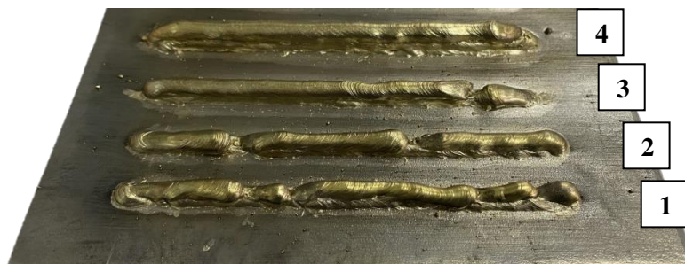
Рис. 1. Формирование наплавленных валиков при изменении сварочного напряжения
