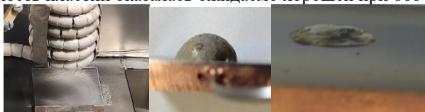
Рисунок 1 Устройство для исследования смачиваемости и вид капли лития после выдержки при температуре 340 °С и 600 °С
