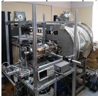
Рис. 1. Фото установки ПЛМ-М с лазерным комплексом Образцы находятся под облучением стационарной гелиевой плазмы в
