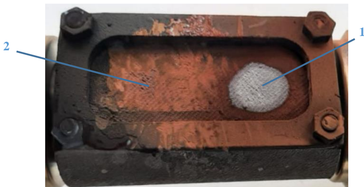
Рисунок 2. – Фотография обращенной к плазме поверхности макета литевой ЖМ КПС после испытаний в установке ПЛМ, 1 - область с литием, 2 - область лазерных нагрузок
