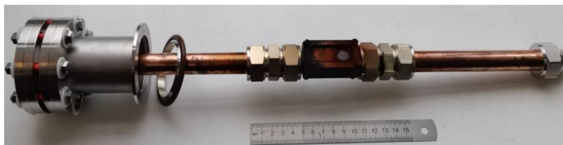
Рисунок 1. – Фотография опытного макета охлаждаемой жидкометаллической капиллярно-пористой системы
