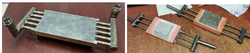
Рисунок 4 - Биметаллические ГИП, CVD и МПВ пластины на охлаждаемых медных подложках для тепловых испытаний
