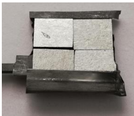
Рис. 2. Вольфрамовые образцы после испытаний лазерной и плазменной нагрузкой в ПЛМ-М
