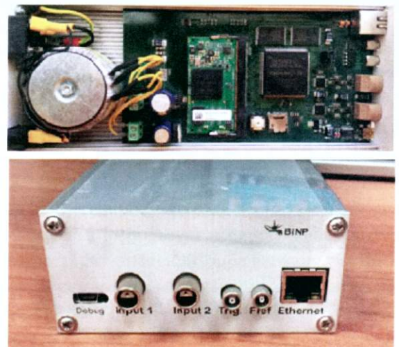
Рис. 13. Фотографии измерительного модуля дисперсионного интерферометра
