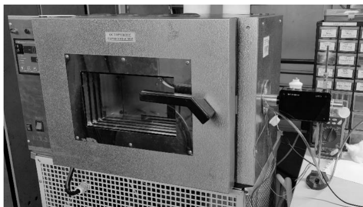
Рис. 2. Внешний вид камеры тепла и холода КТХ-20М
