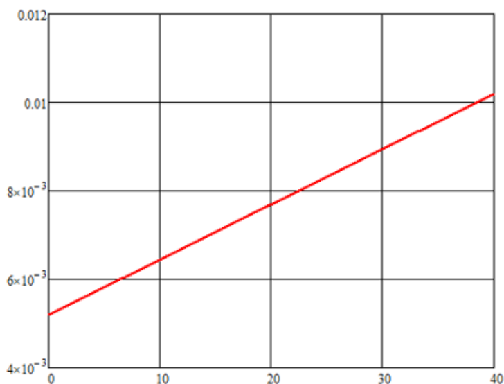
Рис. 2. Зависимость шероховатости поверхности оксида алюминия от времени обработки в плазме Ar
