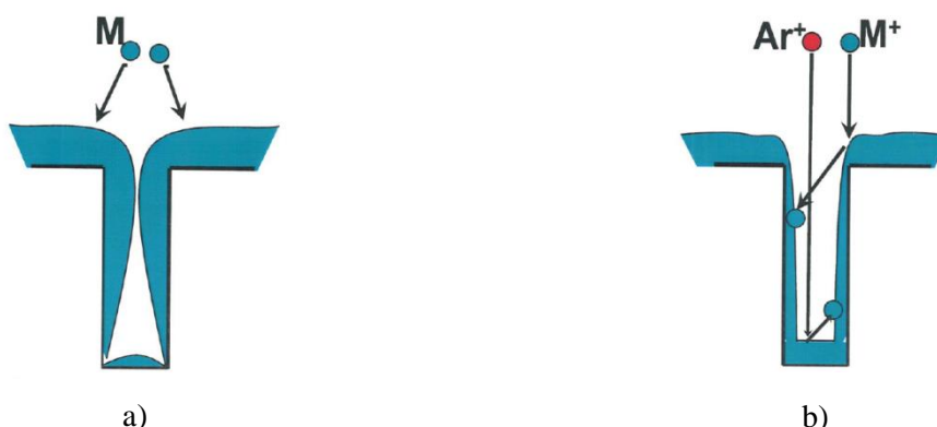
Рис. 2. Схема осаждения с использованием нейтральных атомов мишени (a) и ионов материала мишени (b)
