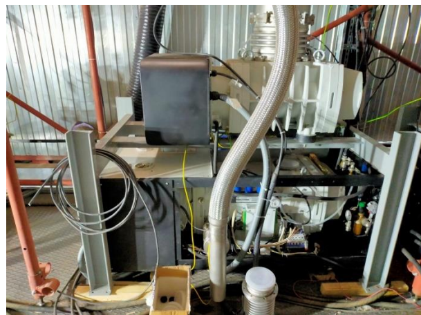
Рис. 5. Внешний вид насоса вакуумного винтового НВВ-630 (слева) и насос вакуумного двухроторного НВД-2100 (производство АО «Вакууммаш», г. Казань)
