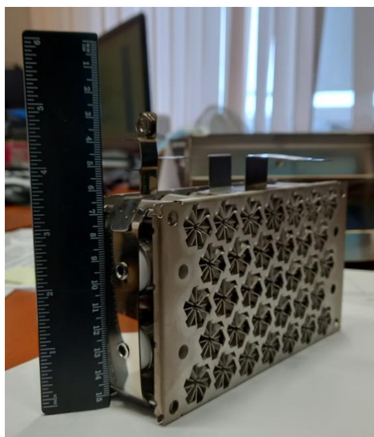
Рис. 2. Внешний вид электродного блока с катодами в виде «StarCell»
