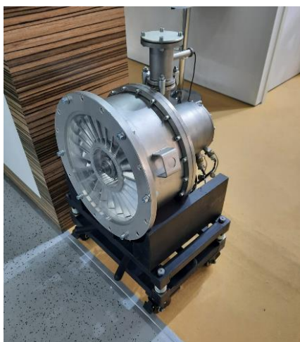
Рис. 12. Внешний вид турбомолекулярного насоса производства АО «Вакууммаш»
