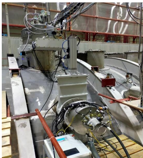
Рис. 6. Внешний вид насоса вакуумного турбомолекулярного НВТ-400 (производство АО «Вакууммаш», г. Казань)
