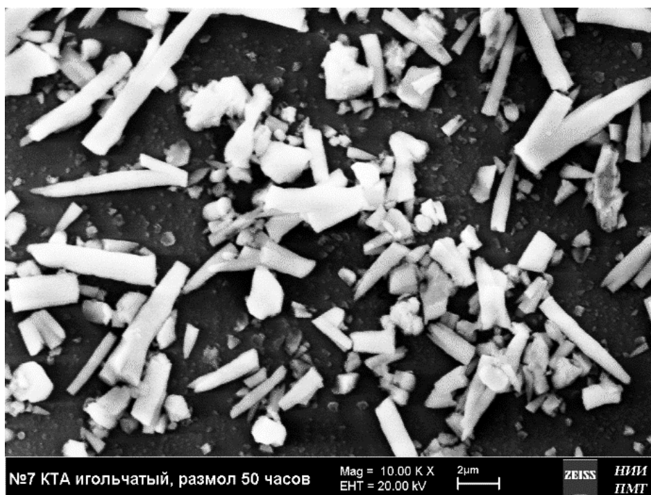
Рис.3. Результаты размола игольчатого тройного карбоната в течении 50 часов. (Увеличение в 10 000 раз)
