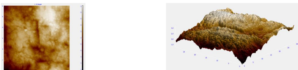
Рис. 7. Изображение топологии эластомера с медным покрытием (после ионной обработки), полученные с помощью АСМ
