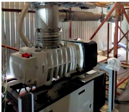
Рис. 5. Внешний вид насоса вакуумного винтового НВВ-630 (слева) и насос вакуумного двухроторного НВД-2100 (производство АО «Вакууммаш», г. Казань)
