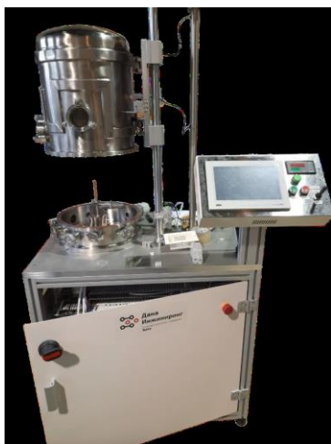
Рис. 5. Внешний вид установки вакуумного напыления SAHA
