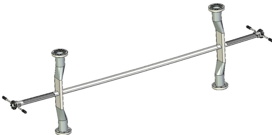
Рис. 5. Внешний вид основного профиля вакуумной камеры
