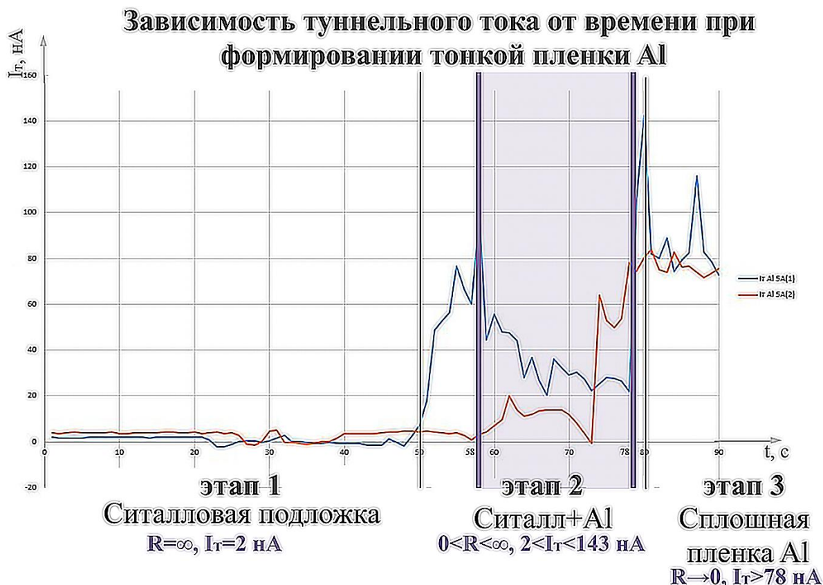
Рис. 8 – Зависимости туннельного тока от времени формирования пленки Al на ситалловой подложке при разных значениях тока на испарителе
