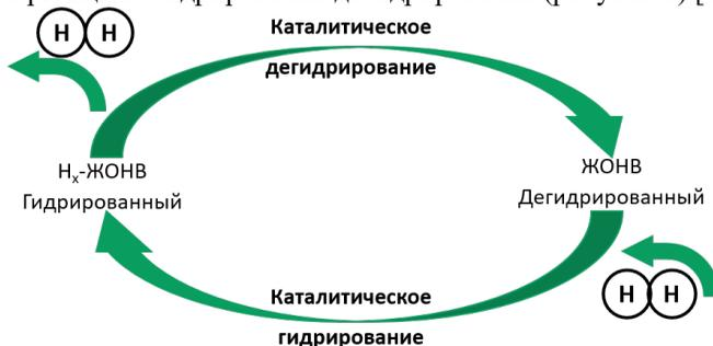
Рисунок 1 – Процессы гидрирования/дегидрирования ЖОНВ
