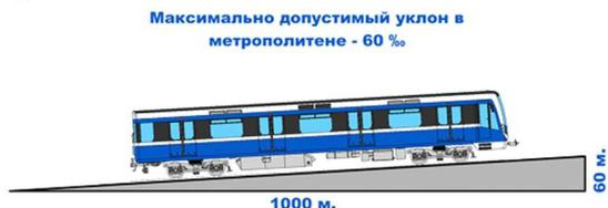
*Рисунок 4 – Наглядная демонстрация уклона.*
