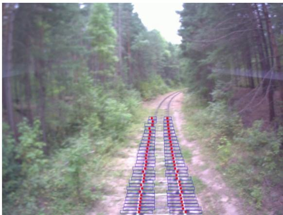
Рис.2. Пример исходного изображения железной дороги с наложенными на него секторами  $\Omega_{ij}$ , которые показаны синими прямоугольниками, положение точки с максимумом сигнала в каждом секторе обозначены красными кружками.
