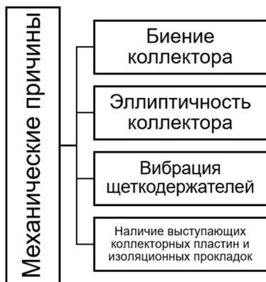
Рис. 1 – механические причины неудовлетворительной коммутации ТЭДПТ
