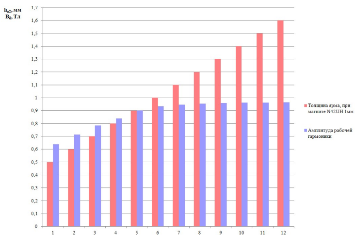
Рисунок 2 - Зависимость амплитуды рабочей гармоники вектора магнитной индукции в воздушном зазоре от толщины ярма ротора
