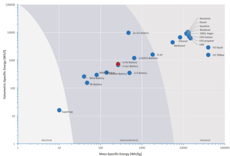
Рис.1 – Сравнение источников питания для БПЛА на основании энергетических показателей по массе и объему [1]
