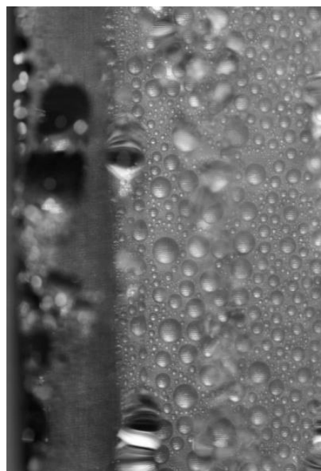
Рис. 2. Конденсация на поверхности с контрастной смачиваемостью
