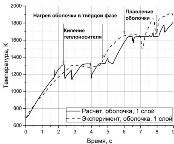
Рис. 1. График зависимости температуры оболочки ТВЭЛов 1 радиального слоя от времени в эксперименте, выполненном на реакторе SCARABEE.
