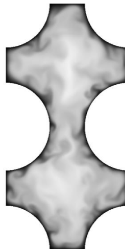
Рис. 1. Сечение модельной сборки из 6 ТВЭЛов с мгновенной продольной скоростью.
