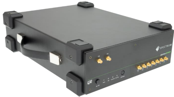
Рисунок 1.1.8.3. Слева – быстрый трансформатор тока FCT от фирмы Bergoz Instrumentation. Справа – быстрый АЦП DN2.222-02 фирмы Spectrum Instrumentation.
