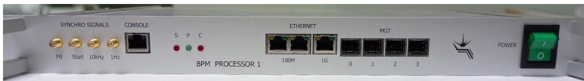
Рисунок 3.7.1.3. Блок электроники BPM Processor для работы с одним пикапом.
