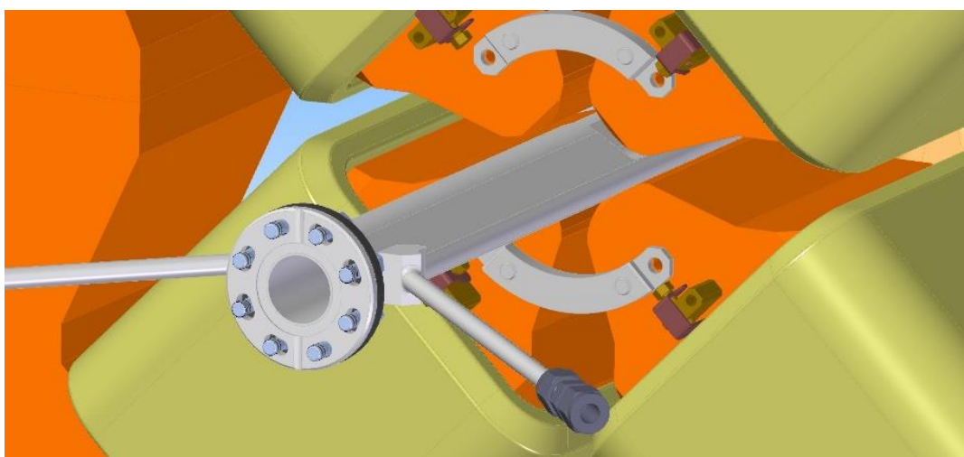
Рисунок 3.2.3.8. Трехмерная модель вакуумной камеры в квадрупольном магните.
