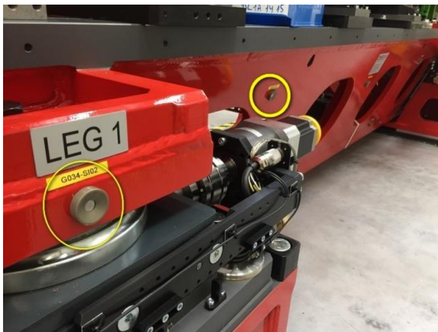
Рисунок 3.8.2. Геодезические знаки с магнитным держателем отражателя.
