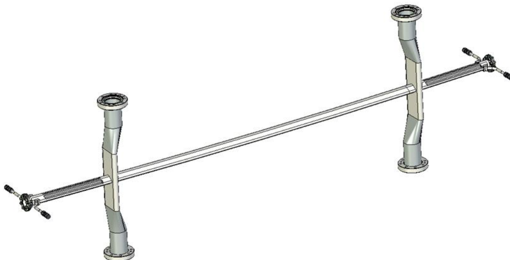
Рисунок 3.2.3.9. Вакуумная камера с малогабаритными вертикальными портами откачки.
