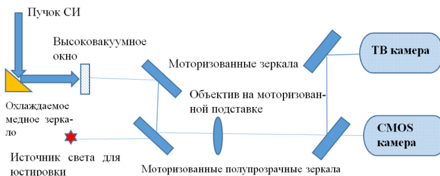
Рисунок 1.2.11.13. Оптическая схема измерения поперечных размеров пучка.
