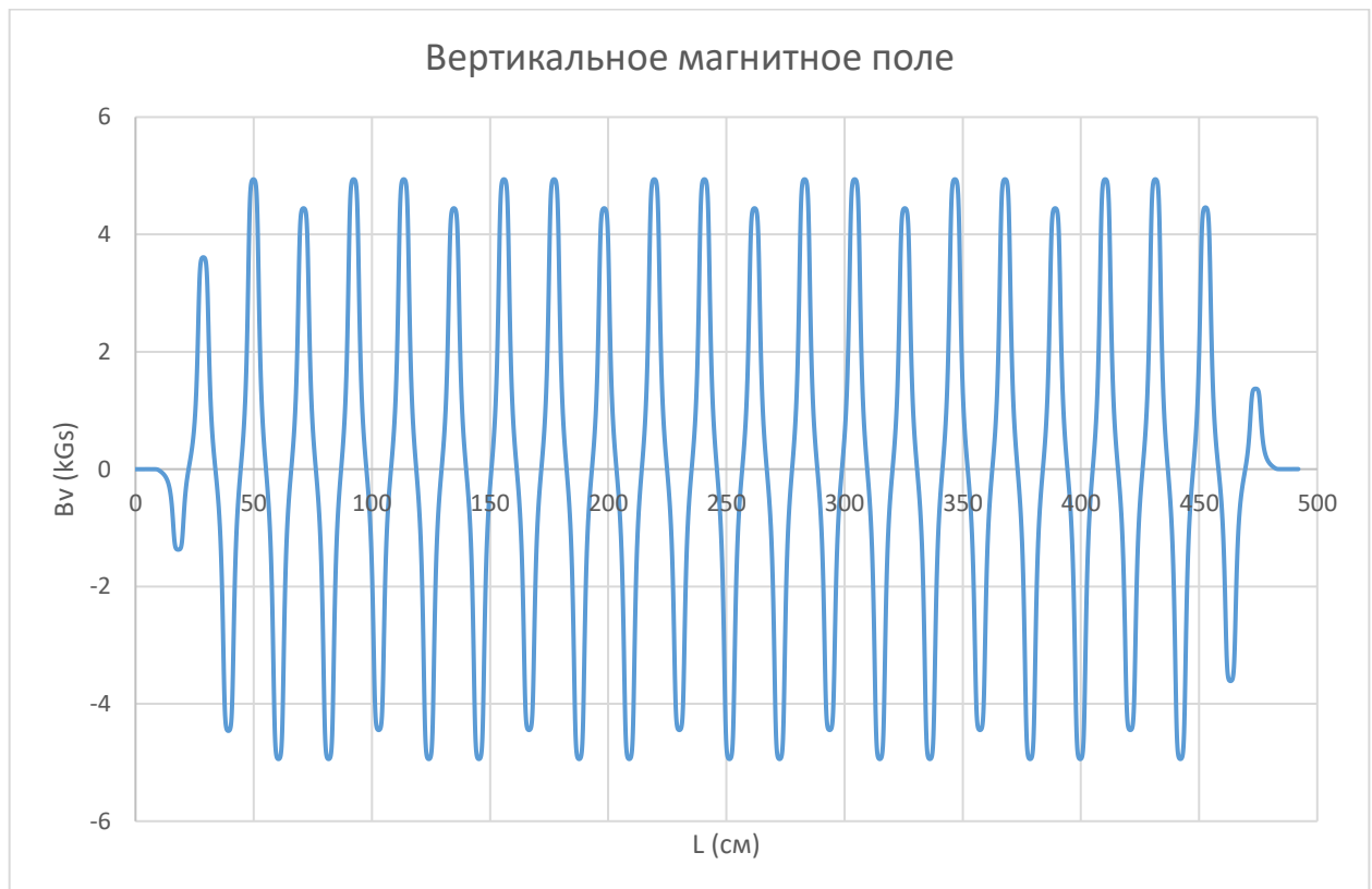
Рисунок 5. Распределение величины вертикального магнитного поля вдоль ондулятора UE212M в режиме подавления гармоник.
