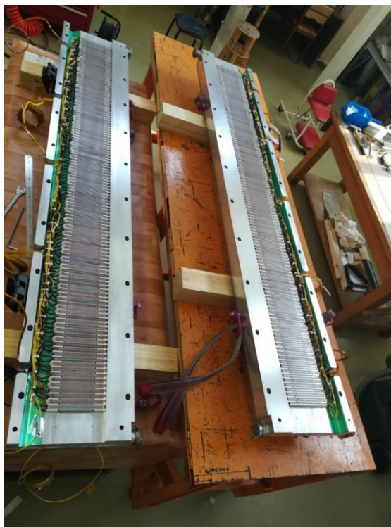
Рисунок 28. Магнитная структура полноразмерного сверхпроводящего ондулятора с периодом 15.6 мм в процессе сборки.
