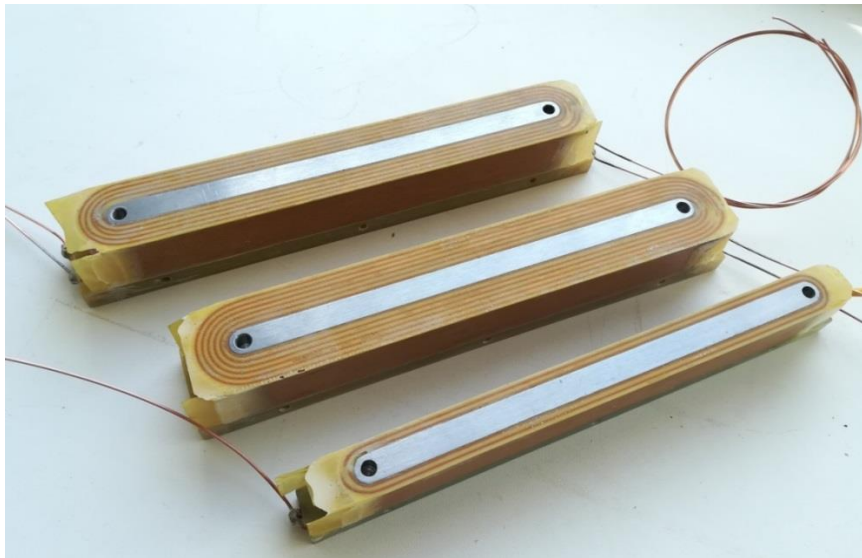
Рисунок 4. Внешний вид основного полюса и боковых полюсов с полем \frac{1}{4} и \frac{3}{4} .
