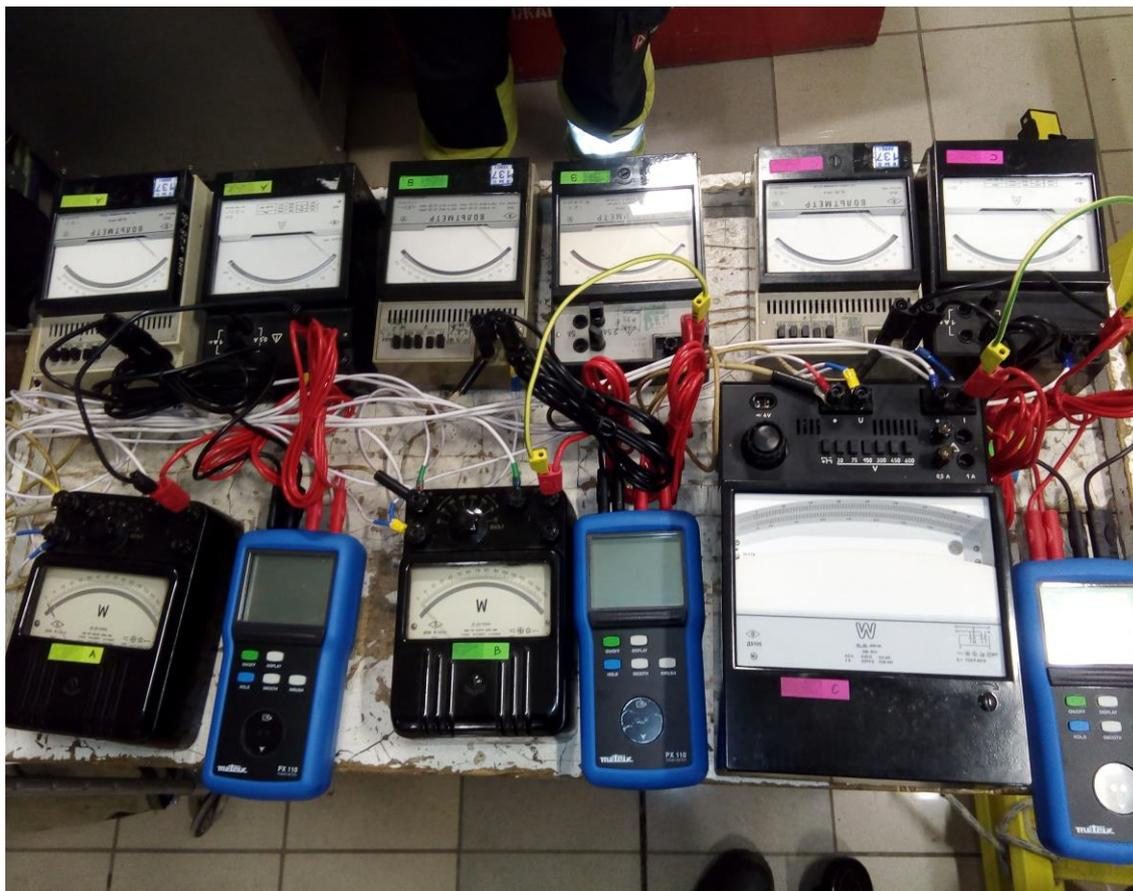
Рис. 1. Опыт потер в режиме Холостого Хода
