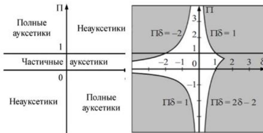
Рис. 1. Классификационная схема кубических аусетиков (а) и классификационная схема с наложением границ устойчивости кубических кристаллов (б)
