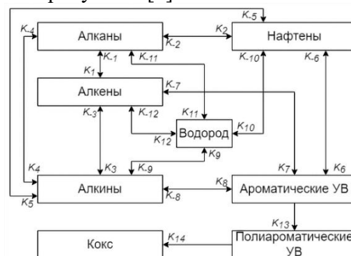
Рисунок 1 – Формализованная схема превращений процесса пиролиза бензиновой фракции
