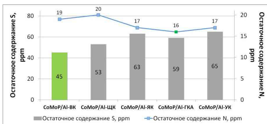
Рисунок 1 – Остаточное содержание S и N в продукте гидроочистки реального сырья при 350 °C
