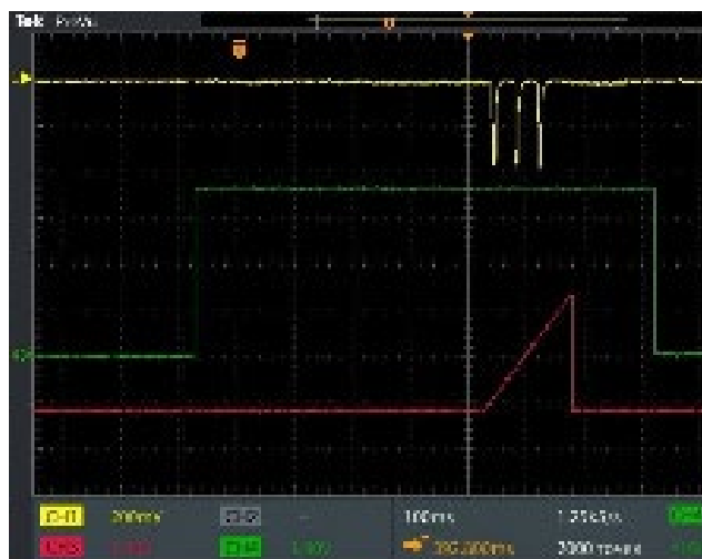
Рисунок 2 – Временная диаграмма измерения. Желтый трек – сигнал с цилиндра Фарадея, зеленый трек – импульс модуляции тока источника, малиновый – импульс модуляции тока сканирующей линзы
