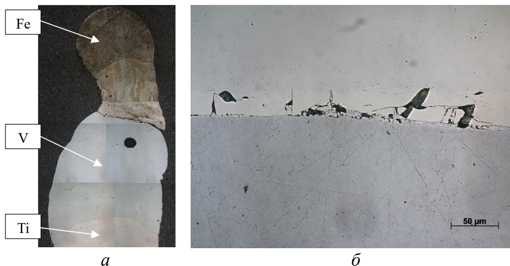
Рисунок 4 – Панорама наплавленных на титан слоев ванадия и железа (а) и микроструктура области сплавления железа с ванадием, 500х (б)
