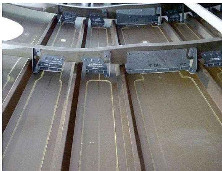
Рисунок 9 – Демонстратор интегральной сварной конструкции, изготовленной лазерной сваркой
