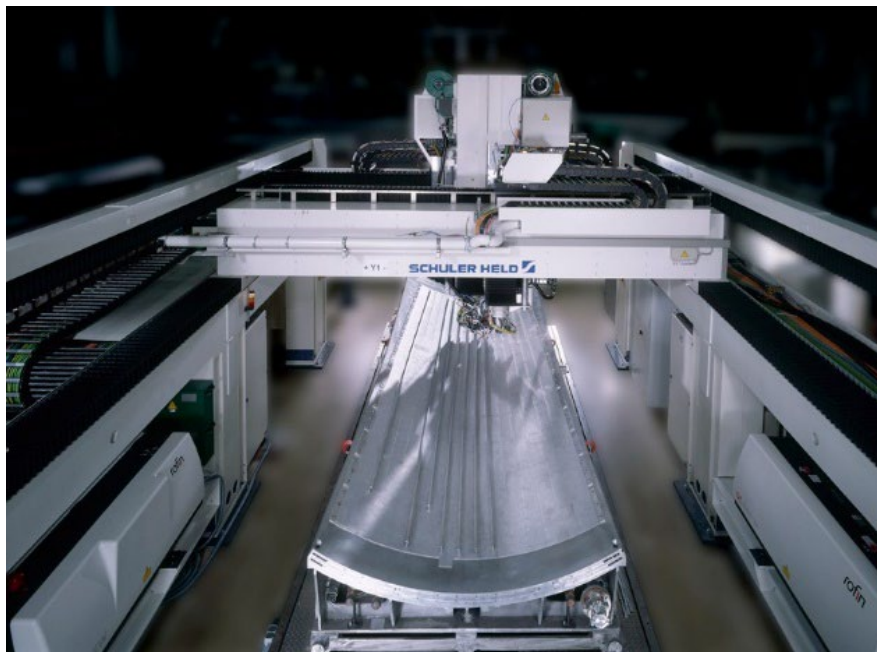
Рисунок 6 – Панель сложной кривизны, изготовленная лазерной сваркой [5]
