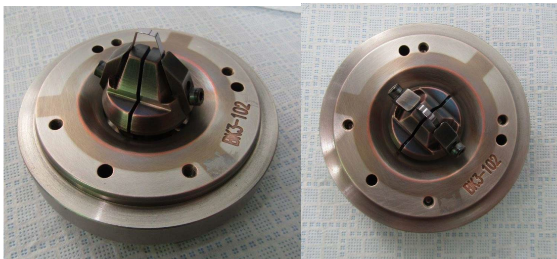
Рисунок 5 – Катод ТЭТА, собранный в катододержатель
