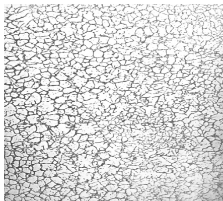
Рисунок 3 – Микроструктуры армко-железа, легированного ванадием (а) и молибденом (б) при перемещении лазерного луча со скоростью 15мм/с, x1000
