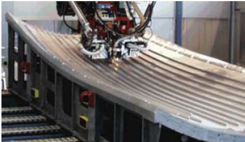
Рисунок 4 – Система позиционирования сварочных головок и зажимания стрингеров (в середине)
