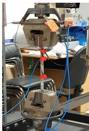
Рисунок 3 – Фото образца в захватах испытательной машины
