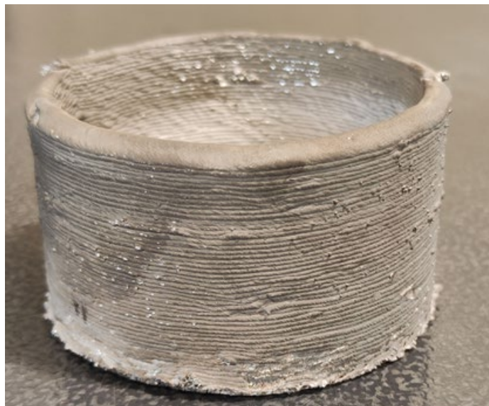
Рисунок 4 – Заготовка в виде цилиндра диаметром 90 мм
