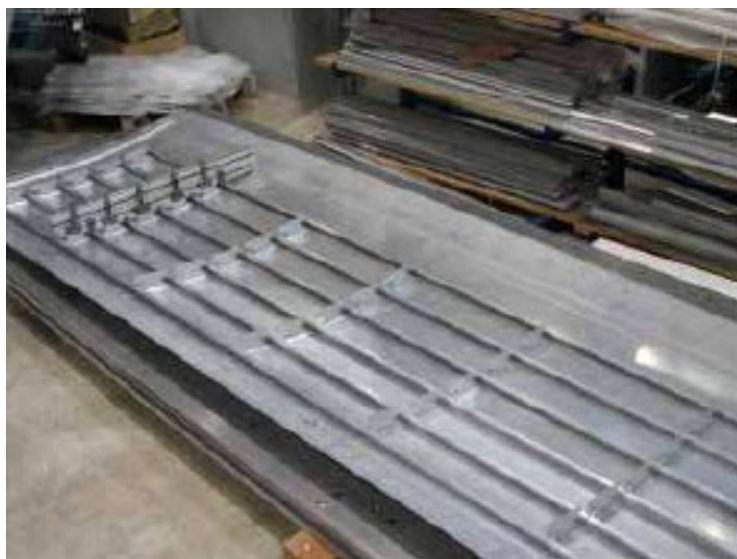
Рисунок 8 – Экспериментальная панель фюзеляжа с приваренными лазерной сваркой стрингерами и скобами
