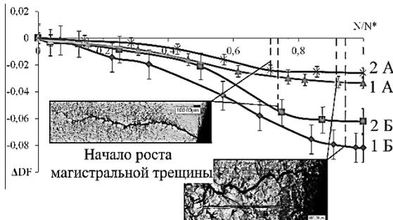
Рис. 2. Зависимость приращения фрактальной размерности от относительного числа циклов для участков перегрева (1) и нормализации (2) ( $\sigma_{\max} = 250$  МПа (А) и  $\sigma_{\max} = 270$  МПа (Б))
