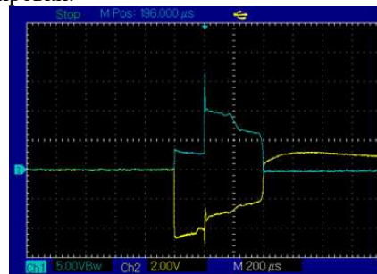
Рисунок 2: Типичные осциллограммы анодного тока модуляторной лампы (верхний луч, 50 А/В) и напряжения на первичной обмотке ИТ (нижний луч, 5 кВ/В) при пробое с включенной системой ПРИЗ.
