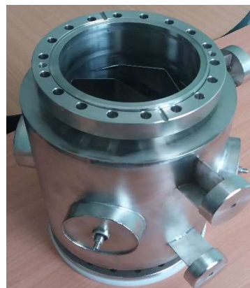
Рис.2. Пикап с апертурой 60 мм.
