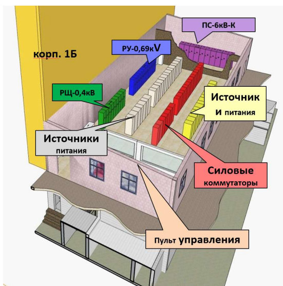
Рис 4: Размещение оборудования системы питания в переключателе пункта, корпус 1Б.
