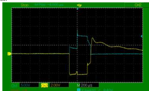
Рисунок 4: Типичные осциллограммы анодного тока модуляторной лампы (верхний луч, 50 А/В) и напряжения на первичной обмотке ИТ (нижний луч, 5 кВ/В) при искрениях в генераторной лампе с отключенной системой ПРИЗ после внесения изменений.
