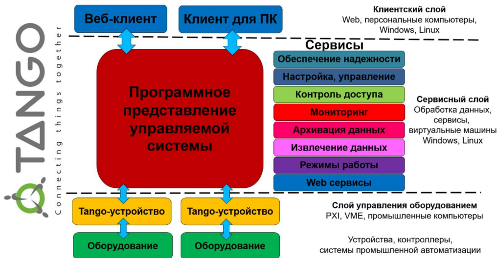
Рисунок 1: Трехуровневая структура системы управления инжекционного комплекса NICA
