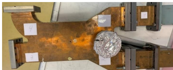
Рисунок 7: 3-х дБ-й ответвитель.
