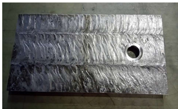
Рисунок 9. Пластина боковой стенки коррозионноустойчивого реактора с отверстием для приварки танталовой трубы. Вид со стороны покрытия.
