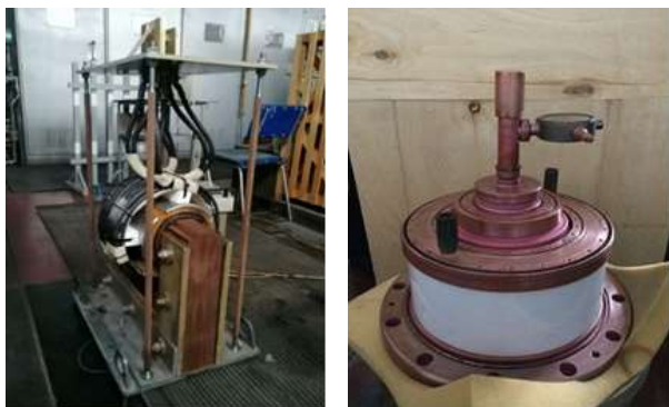
Рисунок 6: Новый ВВ трансформатор накала для лампы ГИ-71АМ (слева) и лампа ГИ-71АМ с вакионом в катоде (справа).
