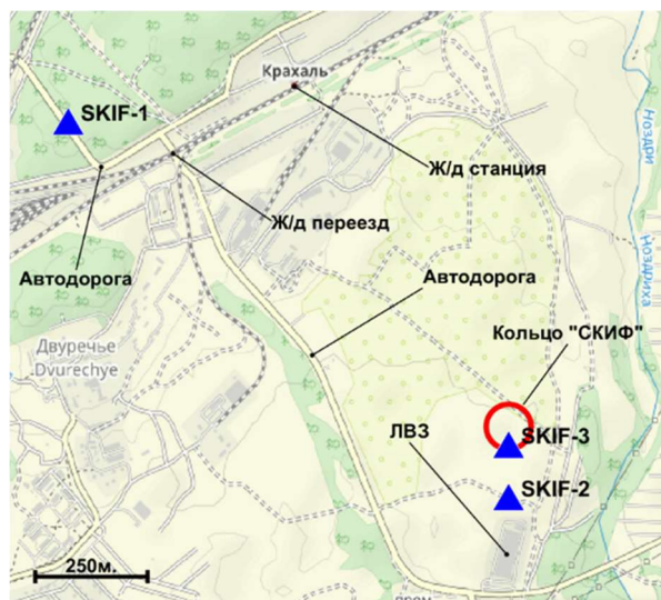
Рис. 2. Карта района работ. Синие треугольники — пункты вибрационных измерений, красная окружность — место строительства кольца источника СИ СКИФ.
