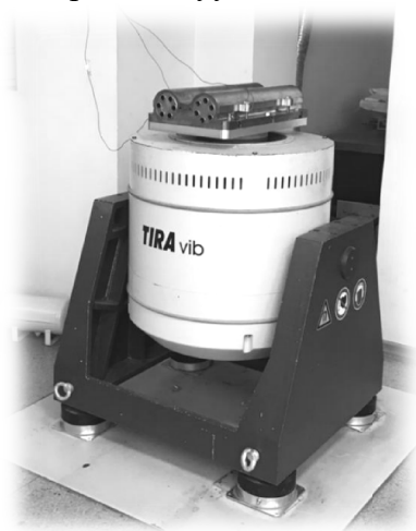
Рисунок 1 – Прототип модуля ДМНП на вибростенде
