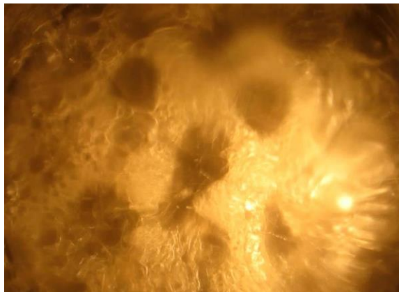
Рис. 1. Фотография «паровых столбов», наблюдавшиеся в тонком слое n -додекана при пузырьковом кипении: высота слоя h = 2.5 мм ( h/l_{\sigma} = 1.45 ), давление в объеме P_s = 20 кПа ( P_s / P_{cr} = 1.1 \cdot 10^{-2} ), q = 108 кВт / м 2 , (T_w - T_s) = 42.1 К.
