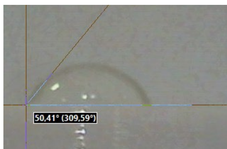
Рис. 3. Изображение капли в процессе определения краевого угла смачивания поверхности напечатанного образца с модельным рисунком 5_Octogram из полимера PETG
