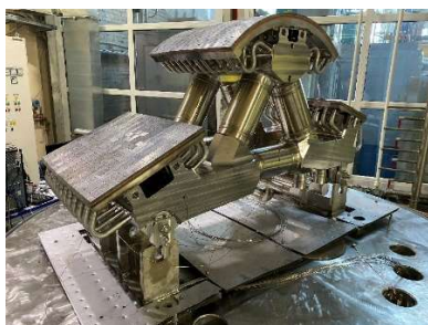
Рисунок 1. Стол вакуумной камеры с установленным прототипом ЦСД (а) и нагреватель ЦСД с крышкой камеры (б).
