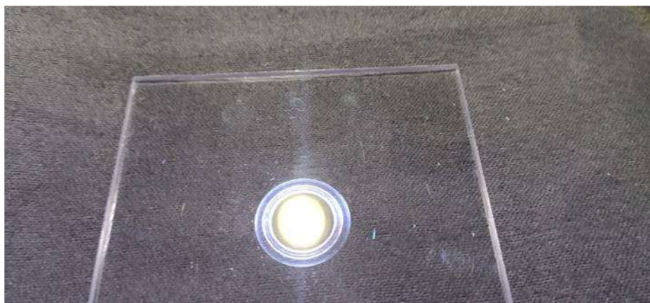
Рисунок 5. Образец из поликарбоната со сквозным следом, возникающим при испытании на абразивную устойчивость.
