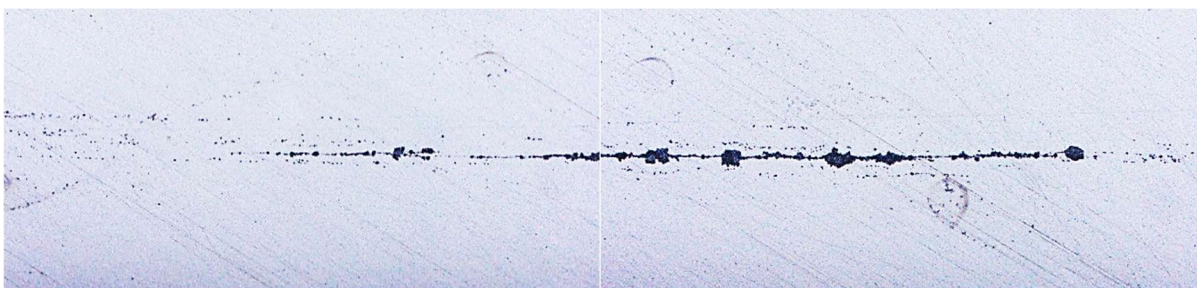
Рисунок 3. Расслоение материала в поперечном шлифе листа, без травления, 100. ×
