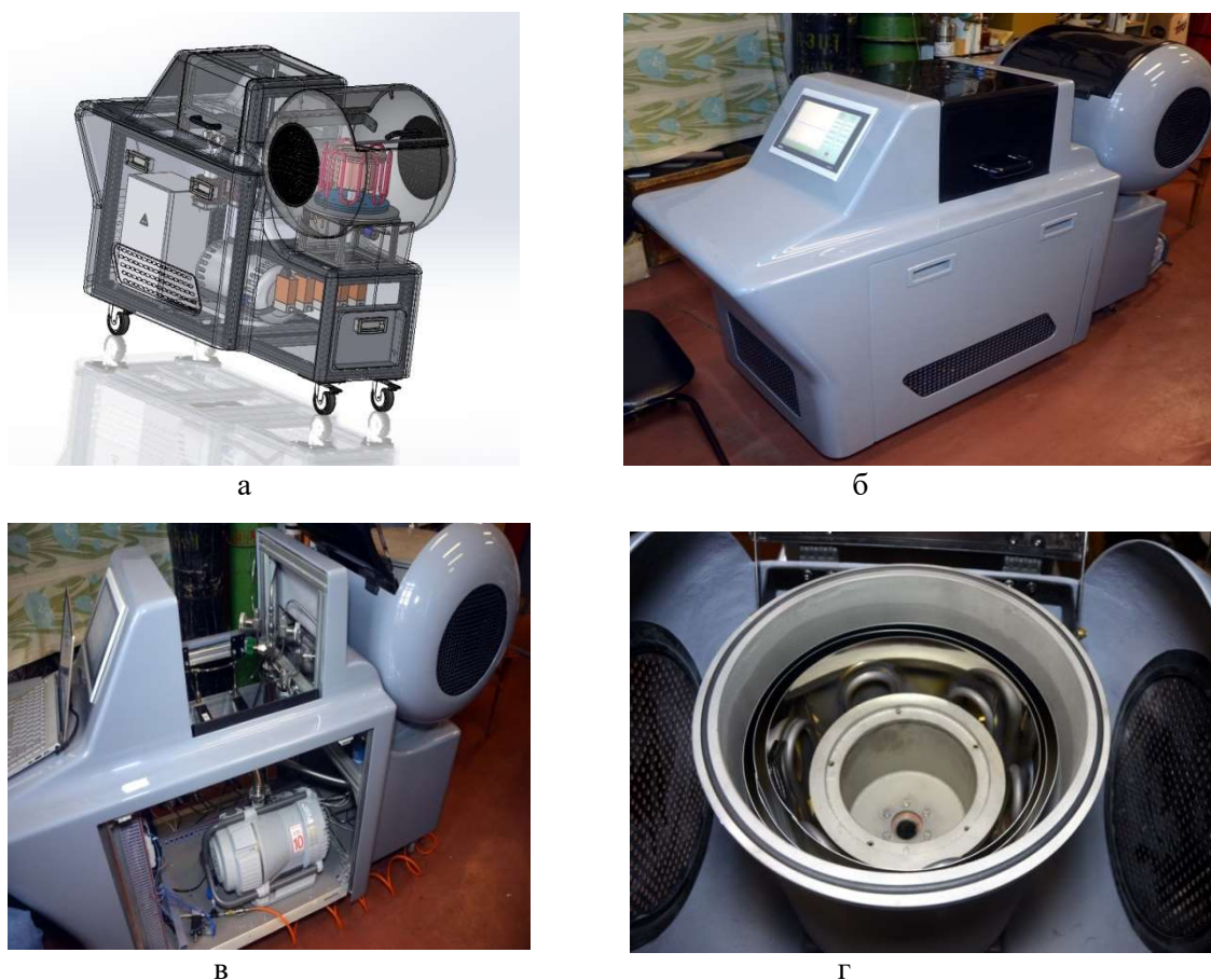
Рисунок 5. Пилотная автоматизированная УМН: 3д изображение (а), общий вид (б), блоки автоматизации, реагентов и откачного средства (в), реакционная камера (г).
