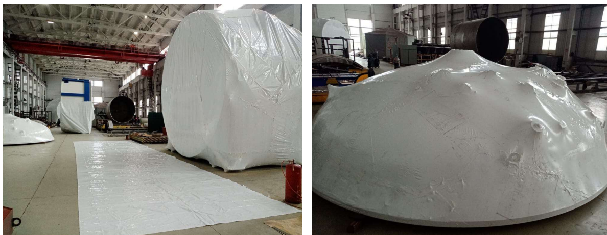
Рисунок 3. Процесс упаковки частей корпуса вакуумной камеры для последующей транспортировки.
