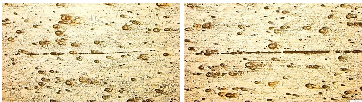
Рисунок 2. Растравы и расслоения в поперечном (слева) и продольном (справа) шлифе, 100. ×
