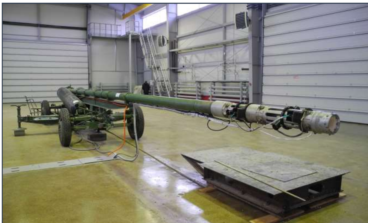
Рисунок 6. Уникальный стенд испытания изделий на птицестойкость.
