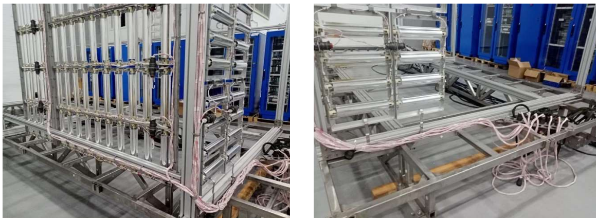
Рисунок 2. Панель излучателей (слева) и одиночный излучатель (справа) системы имитации теплового потока.
