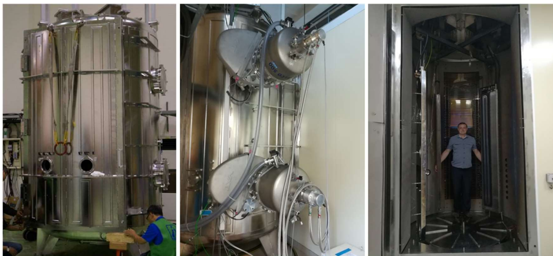
Рисунок 2. Вакуумная установка напыления тонкопленочных покрытий на изделия авиационного остекления.
