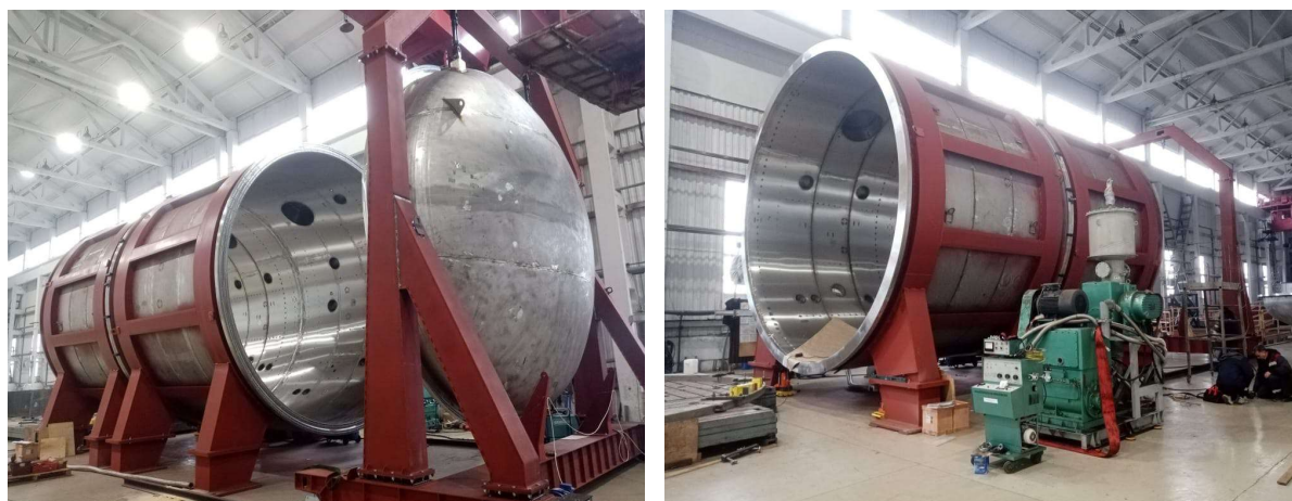
Рисунок 1. Корпус вакуумной камеры для термовакуумных испытаний в процессе производства.
