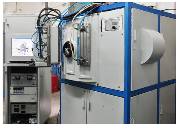
Рис.5. Схема (а) и фотография внешнего вида модернизированной установки «КВИНТА». 1 – дуговой испаритель ДИ100, 2,3 – дуговые испарители ДИ80, 4 – двухкатодная система фильтрации, 5 – вакуумная камера, 6 – образцы, 7 – держатель образцов, 8 – система фильтрации с поворотом потока на 120 градусов, 9 – накалинные катоды плазмоденератора «ПИНК-П04М», 10 – корпус плазмоденератора «ПИНК-П04М», 11 – дуговой испаритель ДИ80.
