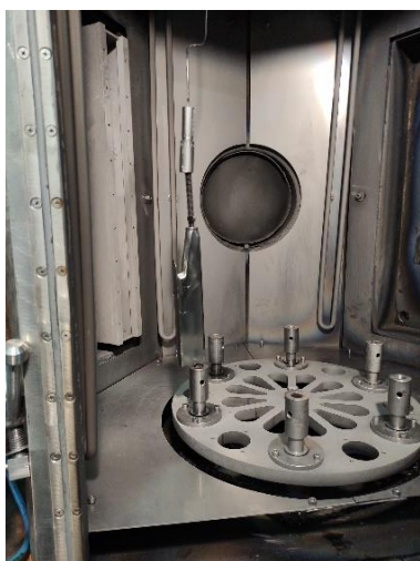
Рис.4. Пример изделия в виде детали бурового оборудования, обрабатываемого на комплексной ионно-плазменной установке "ЭЛИОН".
