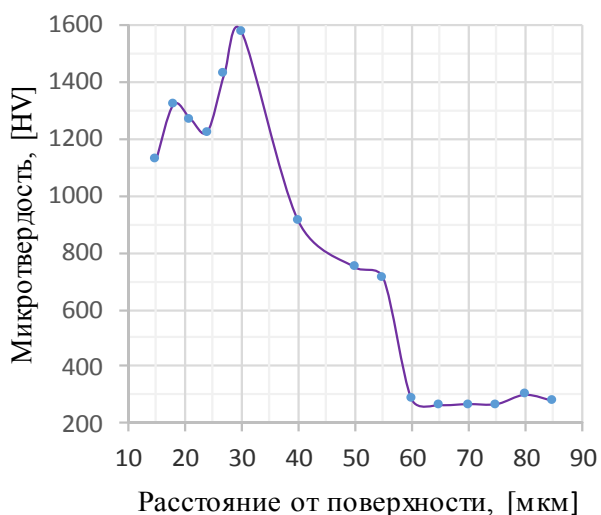
Рис.5. График показателя микротвердости в образце № 1 ( B_4C ) в зависимости от расстояния от поверхности.
