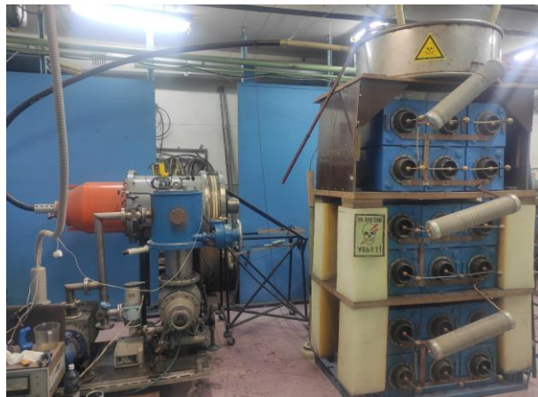
Рис.2. Модернизированный источник электронов «КИЛОАМПЕР» с СПЭ.
