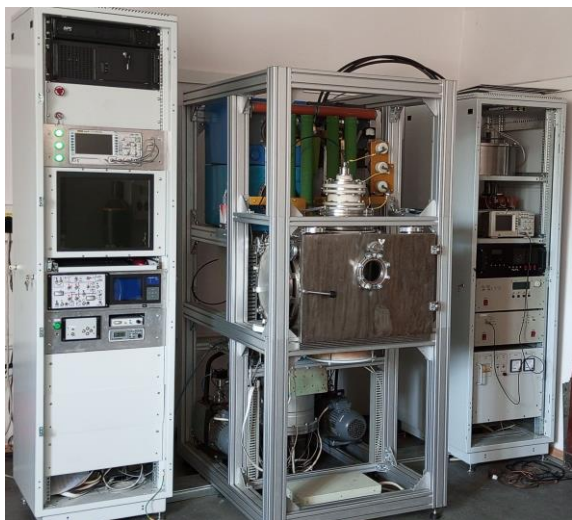
Рис.1. Новая электронно-пучковая установка «СОЛО» на основе плазменного эмиттера.
