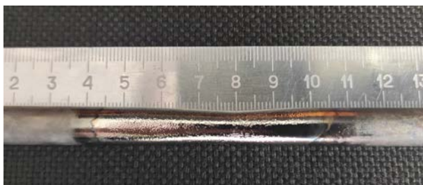
Рис.10. Анод из нержавеющей стали после 21-й тысячи импульсов пучка. U_{ch} = 17 кВ.
