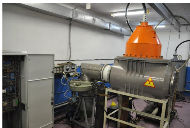
Рис.3. Внешний вид источника электронов с СПЭ «ДУЭТ».
