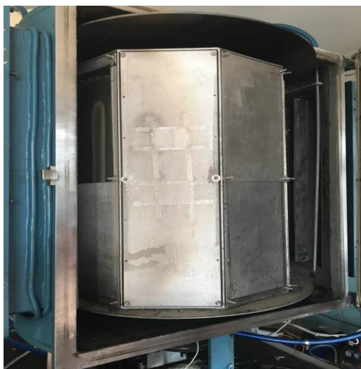
Рис.5. Оснастка для установки подложек
