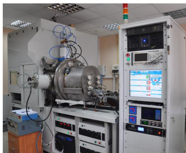
Рис.7. Схема основных узлов (а) и фотография внешнего вида установки «КОМПЛЕКС» (б). 1 – источник электронов «СОЛО», 2 – верхняя магнитная катушка источника электронов «СОЛО», 3 – рабочая вакуумная камера электронно-пучковой обработки, 4 – жалюзийный шибер, 5 – блок питания магнетронной распылительной системы, 6 – магнетронная распылительная система, 7 – блок питания генератора газовой плазмы «ПИНК», 8 – генератор газовой плазмы «ПИНК», 9 – блок питания дугового испарителя ДИ80, 10 – дуговой испаритель ДИ80, 11 – рабочая вакуумная камера объёмной плазменной обработки, 12 – нижние магнитные катушки источника электронной «СОЛО», 13 – манипулятор, 14 – блок питания смещения.
