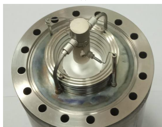
Рис.1. Схема эксперимента (а) и фотография магнетронного распылителя (б). 1 – мишень (катод) магнетрона, 2 – анод магнетрона, 3 – постоянные магниты, 4 – магнитопровод, 5 – катод вакуумной дуги, 6 – анод вакуумной дуги, 7 – инициирующий электрод, 8 – подложка, 9 – образец.
