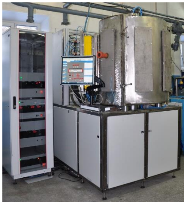
Рис.3. Схема и фотография установки "ЭЛИОН" для комплексной ионно-плазменной обработки материалов и изделий. 1 – вакуумная камера, 2 – генератор газовой плазмы «ПИНК-П06М», 3 – протяжённый дуговой испаритель, 4 – протяжённый магнетрон, 5 – обрабатываемая деталь, 6 – планетарный стол для деталей.
