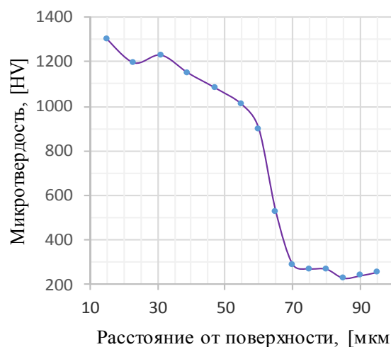
Рис.7. График показателя микротвердости в образце № 2 ( B_4C+Al ) в зависимости от расстояния от поверхности.
