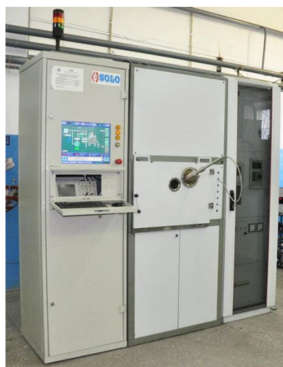
Рис.1. Схема обработки в импульсной электронно-лучевой установке и внешний вид установки СОЛО (ИСЭ СО РАН): 1 – плазменный катод; 2 – электронный пучок; 3 – линза; 4 – кварцевое стекло; 5 – оптоволоконный кабель; 6 – образец; 7 – термopара; 8 – стол-манипулятор; 9 – мультиметр; 10 – высокоскоростной инфракрасный пирометр; 11 – осциллограф.
