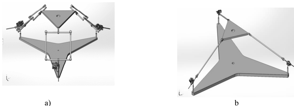
Рис. 1. а) механизм поступательной структуры с тремя степенями свободы; б) расчётная схема механизма с тремя степенями свободы.
