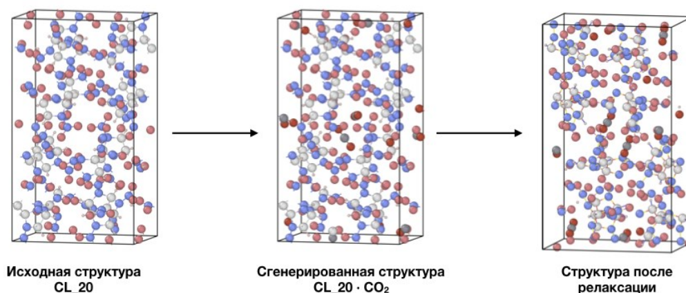
Рис. 2. Поиск стабильной структуры сольвата CL-20 · CO 2 : применение генератора случайных структур к фиксированному окружению исходной ячейки и релаксация полученной структуры в потенциале ReaxFF при стандартных условиях
