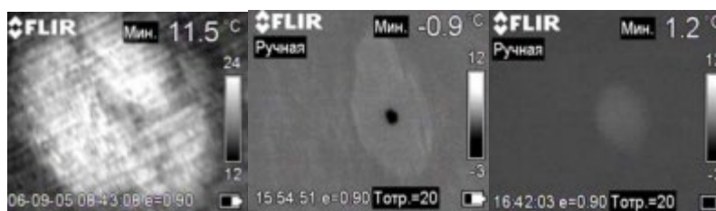
Рис. 3. Внешний вид проявления дефектов подземного трубопровода на поверхности в инфракрасном диапазоне [6].
