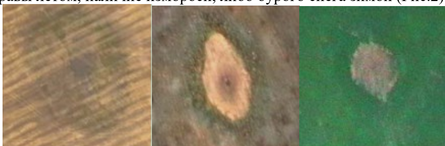
Рис. 2. Внешний вид проявления дефектов подземного трубопровода на поверхности в видимом диапазоне [6].
