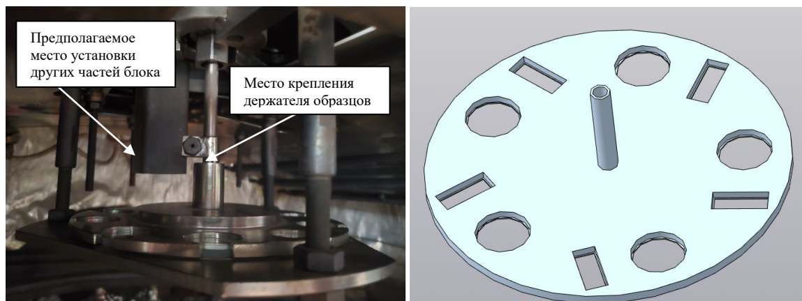
Рис. 4. а) Место установки блока контроля в камере ВУ-1 (слева), б) Модель держателя образцов (справа).
