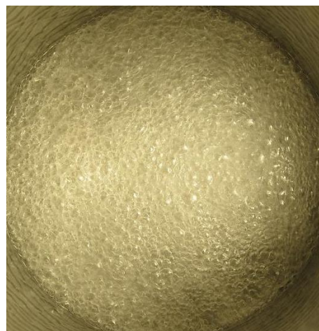
Рис. 2. Пузырьковое кипение в слое HFE–7100 высотой 10 мм при давлении 1 атм. Плотность теплового потока q = 23,1 кВт/м 2 , температурный напор T_w - T_s = 18 К.
