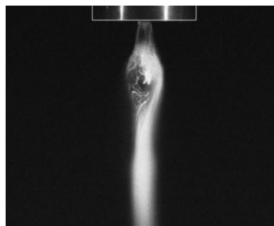
Рис. 1. Истечение струи жидкости, инжектируемой в сверхзвуковой спутный газовый поток, в вакуумную камеру с подсветкой по методу «лазерного ножа».
