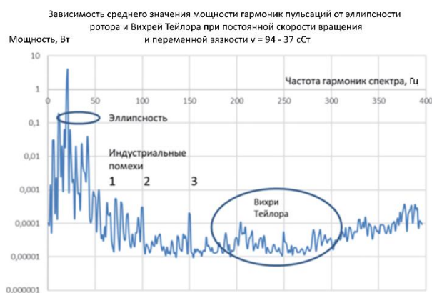
Рис. 1. Пример амплитудно-частотного спектра пульсаций момента сопротивления вращению внутреннего цилиндра
