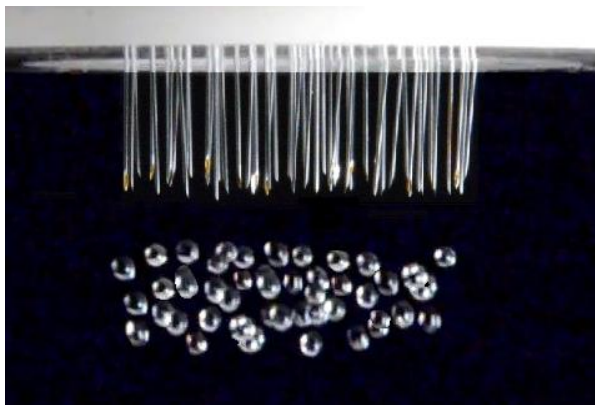
Рис. 1. Фотография монодисперсного кластера из 60 капель диаметром 2.1 мм.
