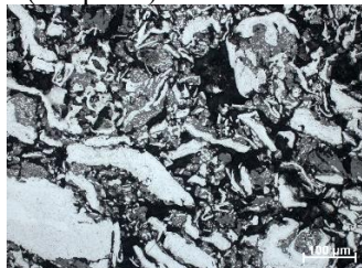
Рис.1 Микроструктура спеченной в вакууме при 800°C прессовки из измельченной и окисленной стружки стали 45.
