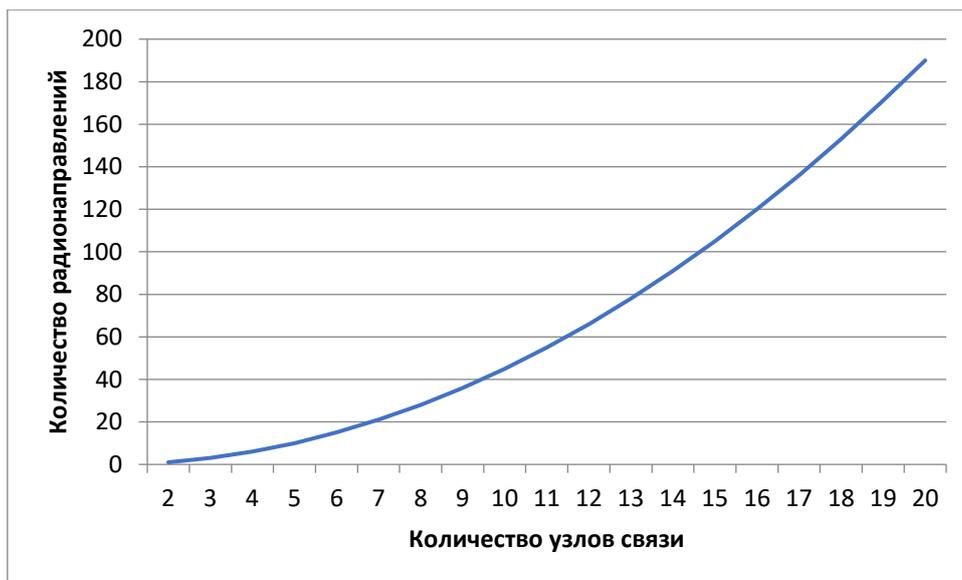
Рисунок 2 – Зависимость количества радионаправлений от количества узлов связи.
