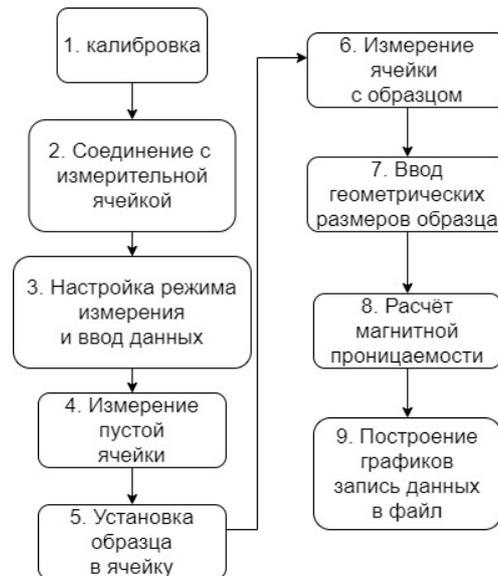
Рис.3 Блок-схема алгоритма измерений и расчета магнитной проницаемости
