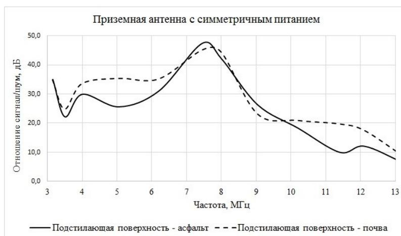
Рисунок 3 Зависимость отношения сигнал/шум в точке приема от частоты
