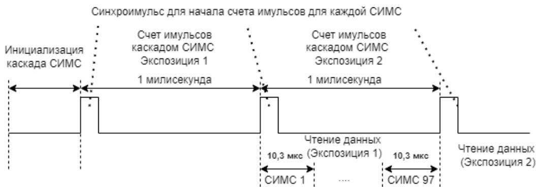
рис. 3. Временная диаграмма счета и сбора данных каскадной системы СИМС
