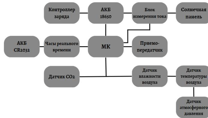
Рис. 1. Блок-схема зонда
